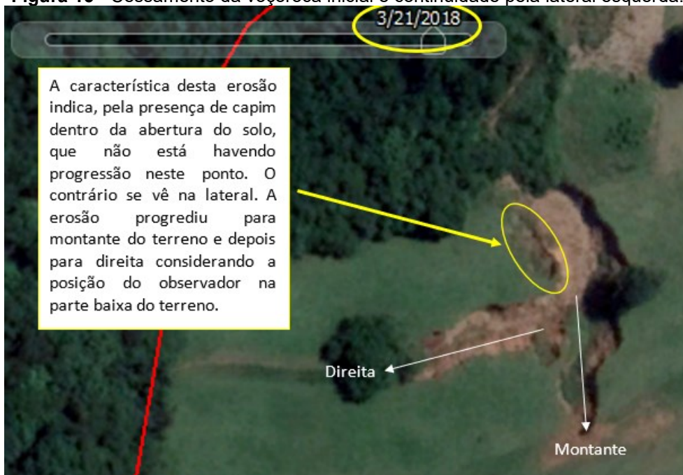
Figura 15 - Cessamento da voçoroca inicial e continuidade pela lateral esquerda.
