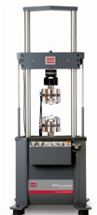
Figura 3.3.1 - Máquina servohidráulica de tração utilizada para realização dos ensaios de fadiga. Fonte: MTS (2026).
