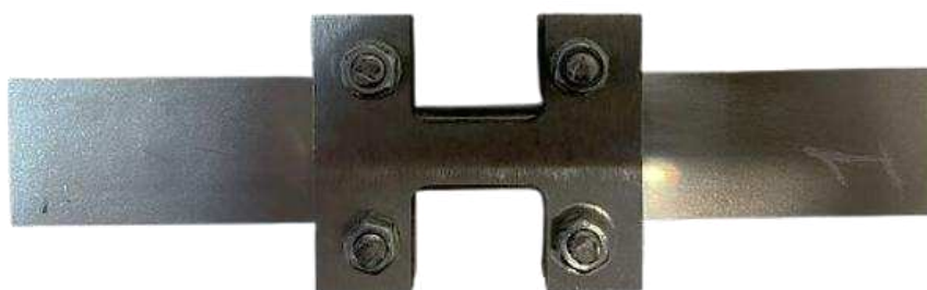
Figura 3.3.4 – Dispositivo antilambagem montado no CP. Fonte: Autor (2026).
