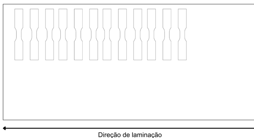
Figura 3.2.3 – Esquema de usinagem dos CPs na chapa de aço laminada, evidenciando a extração na direção paralela à laminação. Fonte: Autor (2026).
