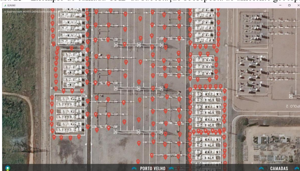
Figura 23 - Exemplo de camada CAD da subestação sobreposta ao ambiente geoespacial.
