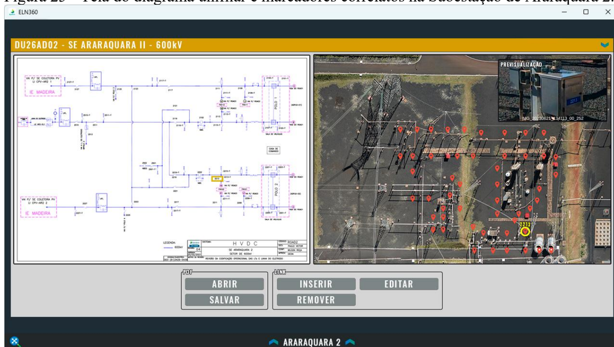
Figura 25 - Tela do diagrama unifilar e marcadores correlatos na Subestação de Araraquara 2.
