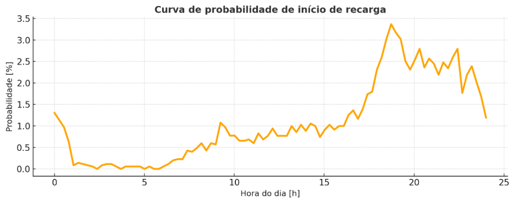
Figura 19 – Curva de probabilidade de início de recarga do veículo elétrico
