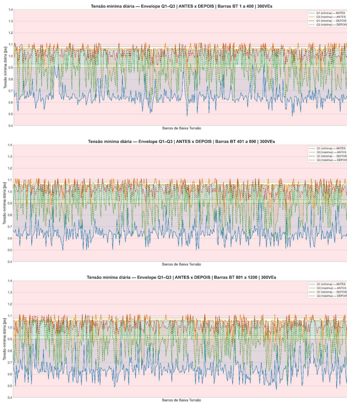
Figura 45 - Tensão diária em pu ao longo do alimentador dos 4 casos estudados antes e depois da alteração da curva de probabilidade
