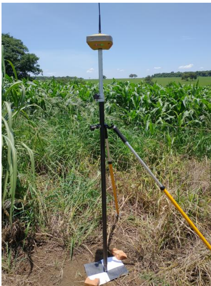
Figura 3 - Receptor GNSS com RTK/Antena Rover GPS RTK no ponto de controle.
