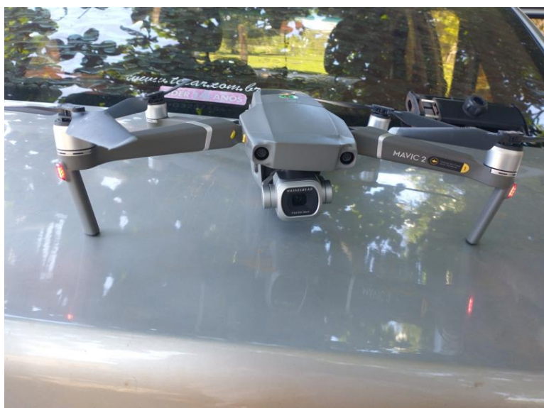
Figura 2 - RPA DJI Mavic 2 PRO com câmera Hasselblad L1D-20c RGB
