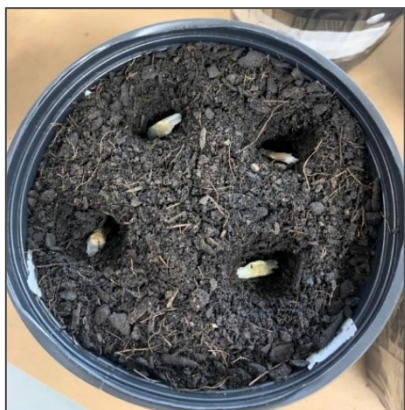
Figura 9 – Semeadura das amostras com sementes de Ipê-de-jardim em ensaio com doses crescentes de lodo de 0%, 12,5%, 25%, 50% e 75%
