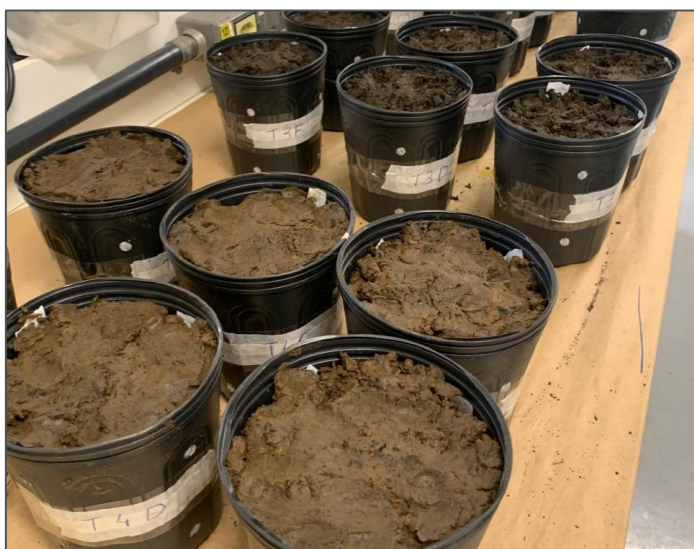
Figura 20 – Tratamentos T3 (50% lodo) e T4 (75% lodo) após o preparo apresentando consistência plástica e pegajosa quando úmida
