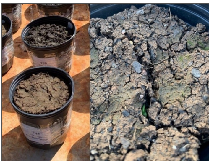
Figura 21 – Exemplos de amostras T3 (50% de lodo) e T4 (75% de lodo) endurecidas após poucos dias no viveiro, em contato com irrigação e sol.
