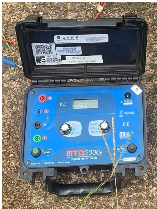
Figura 18: Terrômetro MTD-2000e utilizado nas medições em campo.
