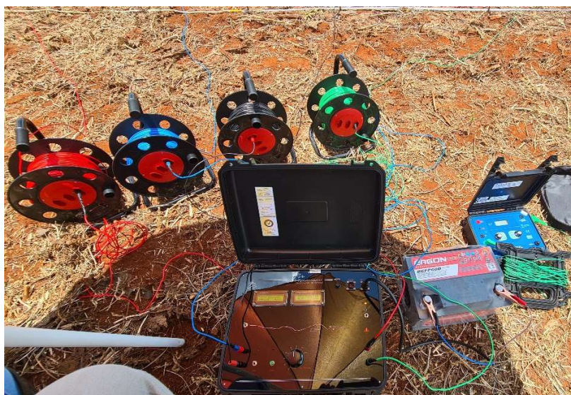
Figura 21: Cabos de conexão e bateria auxiliar do resistivímetro utilizados nos ensaios de resistividade.
