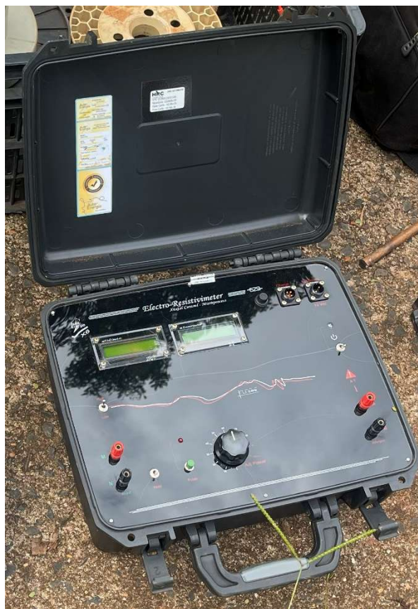
Figura 19: Resistivímetro X6XTAL 500 utilizado nos ensaios.
