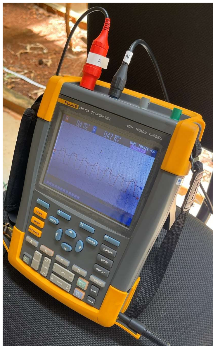
Figura 22: Osciloscópio Fluke 190-104 utilizado no experimento.
