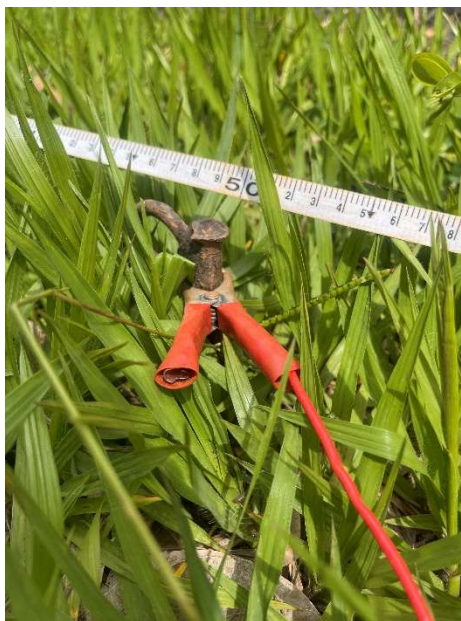
Figura 27: Cravação e cabo conectado à estaca.
