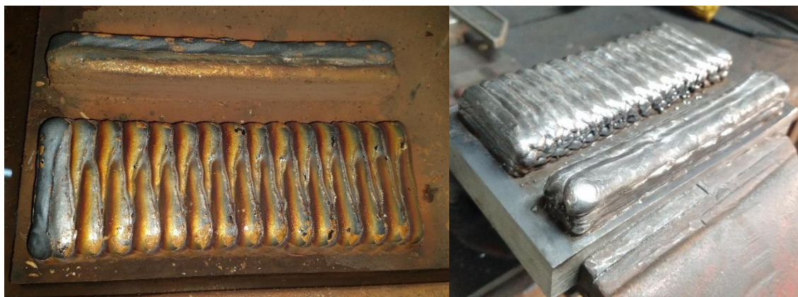
Figura 4.06 – Paredes depositadas para teste de integração
