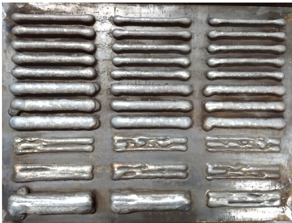
Figura 4.21 - Chapa dois com 33 paredes depositadas em aço inoxidável.
