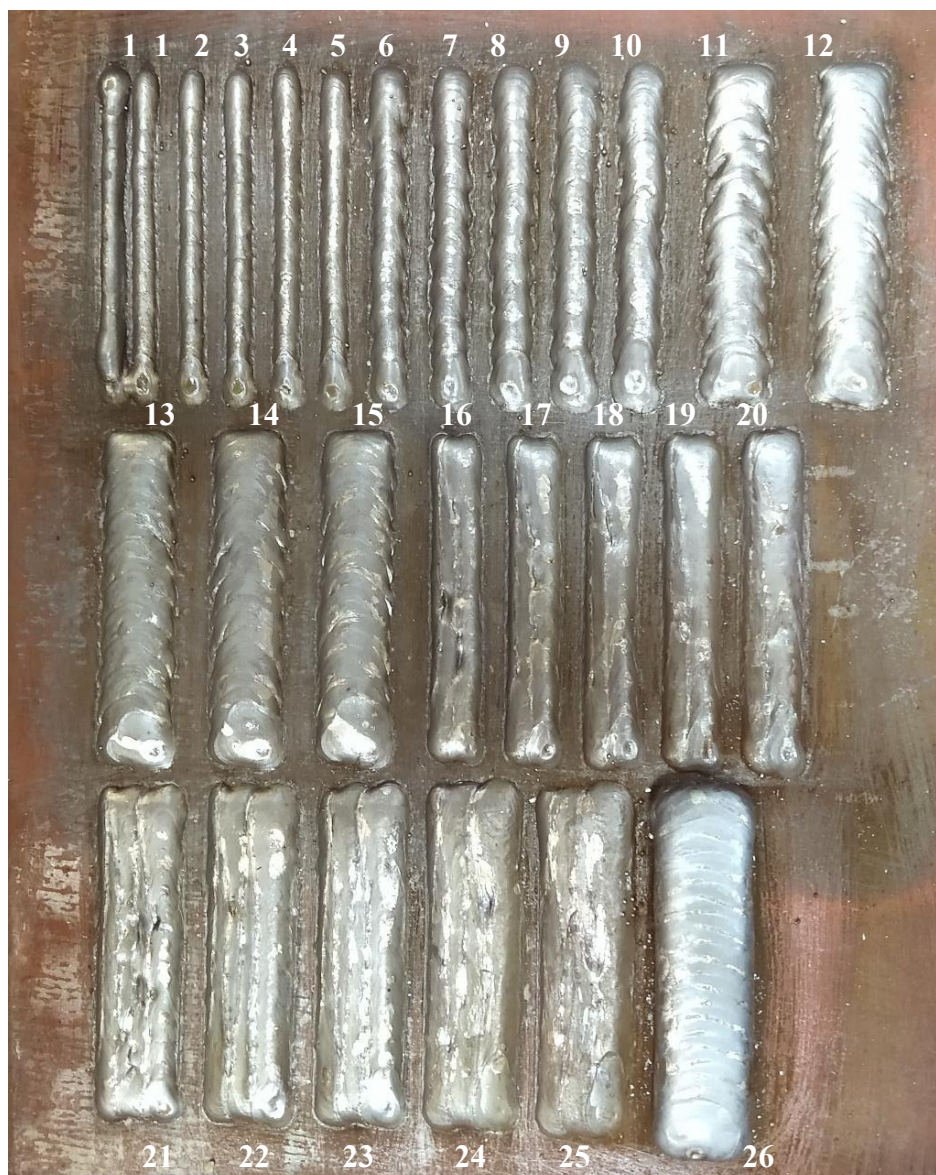
Figura 4.01 – Teste preliminar em Aço Carbono de trajetória e parametrização.
