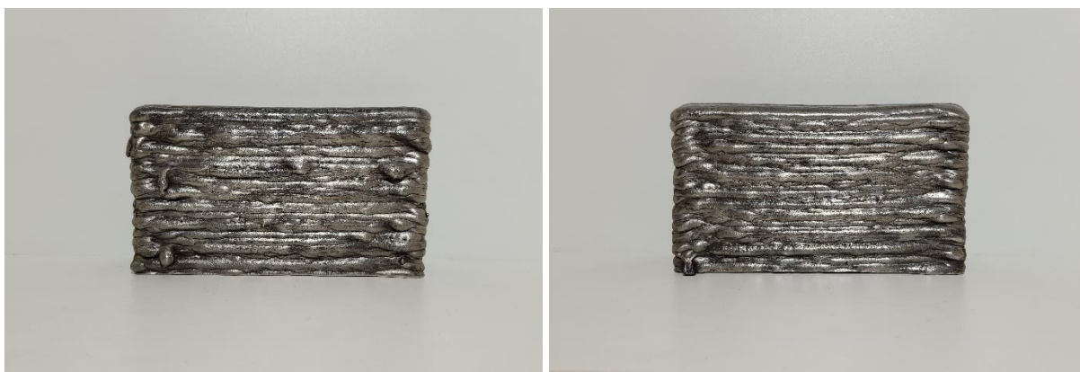
Figura A1.24 - Vista frontal (à esquerda) e vista posterior (à direita) da peça principal IG-04.
