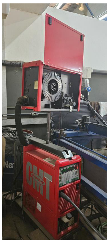
Figura 3.07 – Fonte de soldagem da Fronius®, modelo TransPuls Synergic 5000 (TPS 5000).
