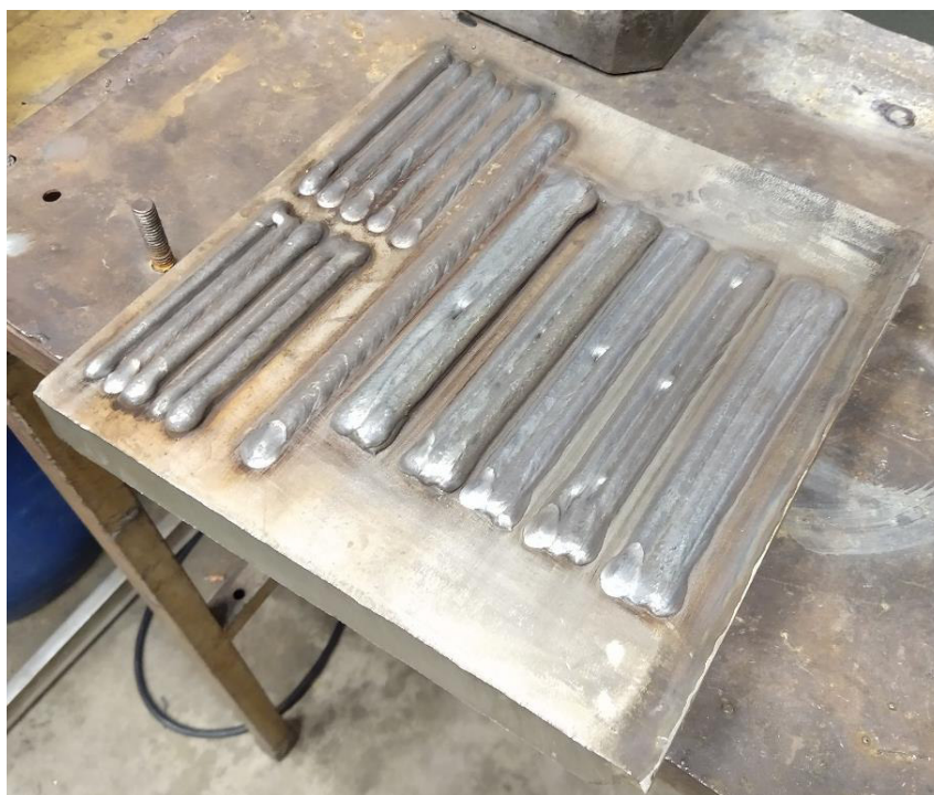
Figura 4.02 – Teste preliminar em Aço Inox para avaliação de trajetória e parametrização.
