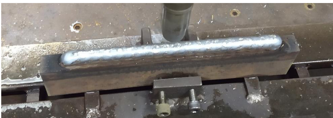
Figura 4.11 – Peça de teste: Camada sem defeitos aparentes
