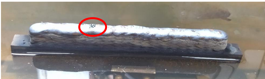
Figura 4.10 – Peça de teste: Camada com porosidade
