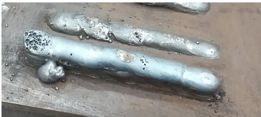
Figura 4.05 – Escoimento e porosidade induzidos.
