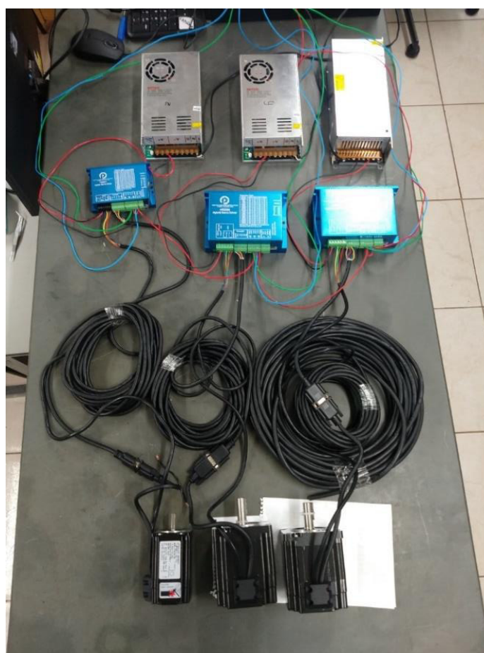
Figura A2.04 - Montagem do Acionamento com Fontes de Alimentação, Drivers e Easy Servos .
