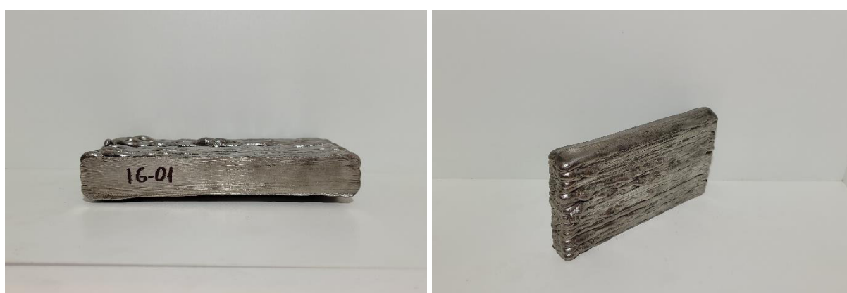
Figura A1.17 – Vista inferior (à esquerda) e vista em perspectiva (à direita) da peça principal IG-01.
