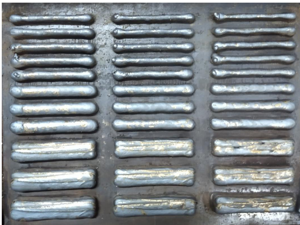
Figura 4.18 – Chapa um com 33 paredes depositadas em aço carbono
