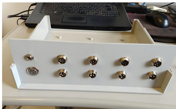
Figura A3.31 - Instalação dos conectores Mike e do botão de liga/desliga do sistema.
