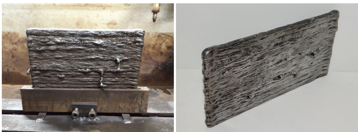
Figura 4.25 – Peça CF-04: (a) término da deposição; (b) pronta para ensaio não destrutivo
