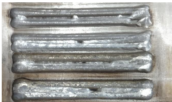
Figura 4.04 – Falta de preenchimento induzida.
