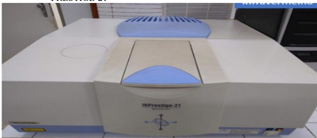
Figura 17 - Espectrômetro de absorção no infravermelho - marca Shimadzu, modelo IR PRESTIGE-21
