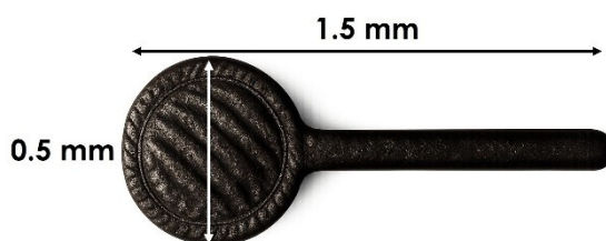
Figura 30. Eletrodo em formato pirulito impresso em 3D com filamento protopasta
