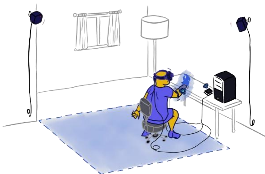
Figura 45 - Área de cobertura da SteamVR Base Station 2.0
