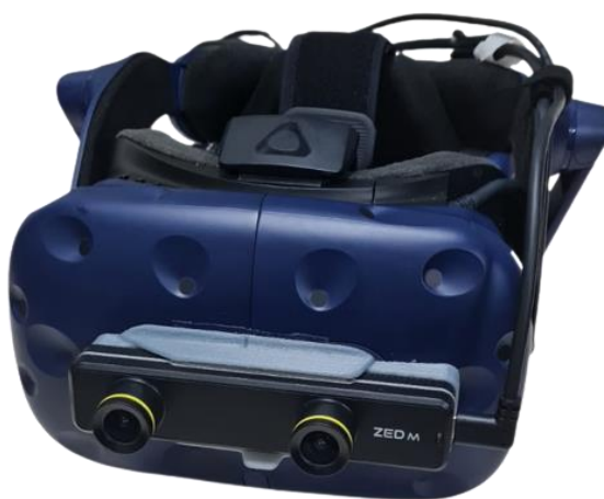
Figura 39 - HMD HTC Vive Pro com Stereolabs Zed Mini acoplada
