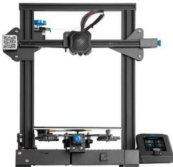
Figura 3.4: Impressora 3D FDM modelo Ender 3 V2 utilizada na fabricação dos atuadores pneumáticos macios.
