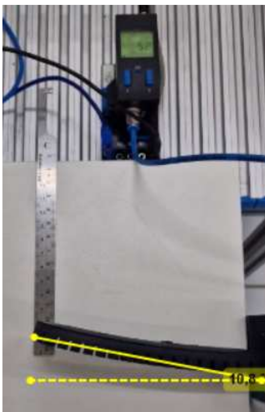
Figura 4.48: Ângulo de deflexão do atuador a 50 kPa.
