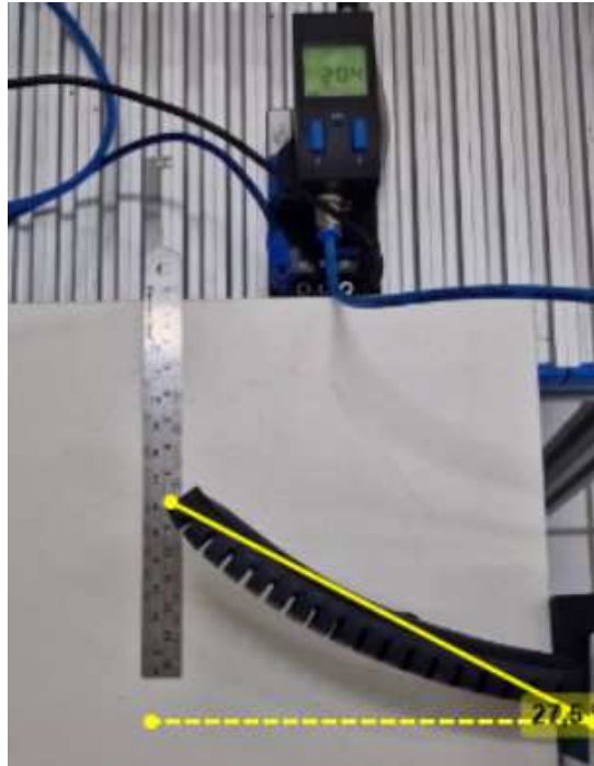
Figura 4.51: Ângulo de deflexão do atuador a 200 kPa.
