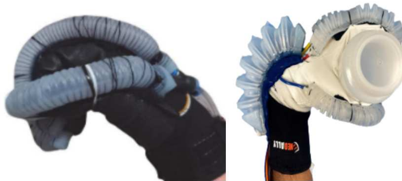
Figura 2.6: Exemplo de exoesqueleto macio para mão e punho com atuadores pneumáticos do tipo PneuNet integrados a uma estrutura vestível, utilizado para assistência e reabilitação de movimentos em membros superiores. Adaptado de Tejada et al. (Tejada et al., 2024) e Ridremont et al. (Ridremont et al., 2024).
