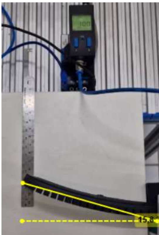
Figura 4.49: Ângulo de deflexão do atuador a 100 kPa.
