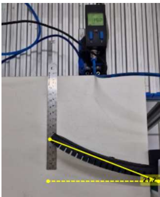
Figura 4.50: Ângulo de deflexão do atuador a 150 kPa.
