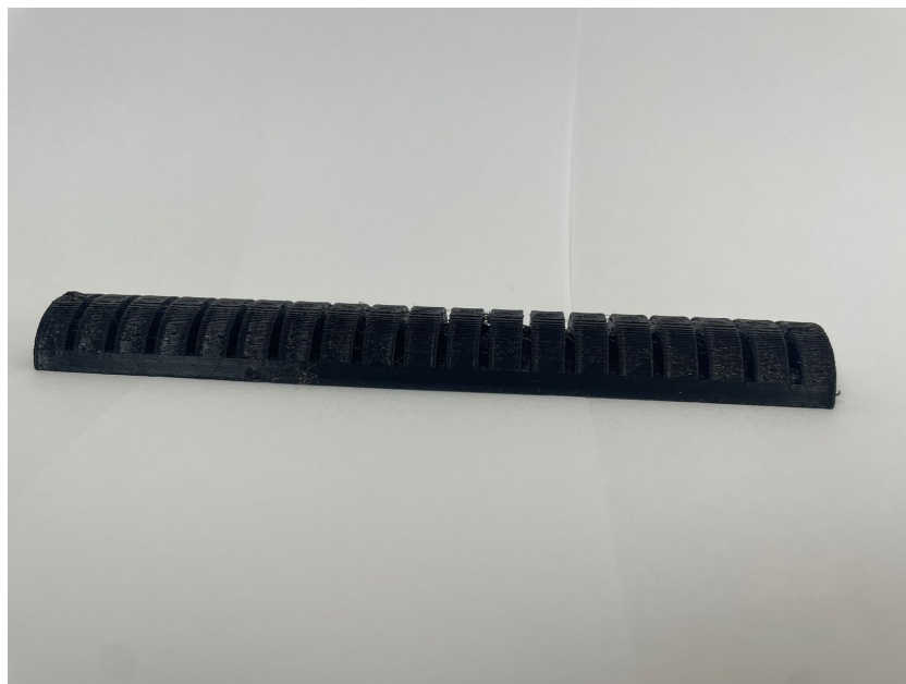
Figura 4.40: Modelo com perfil retangular e paredes curvadas impresso.
