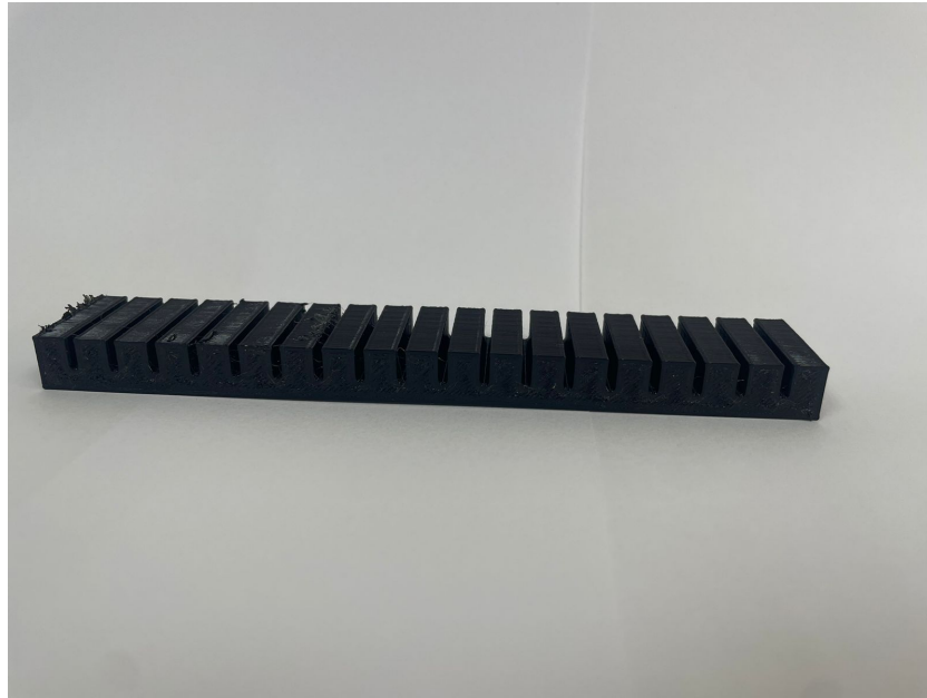
Figura 4.39: Modelo com perfil retangular e paredes planas impresso.
