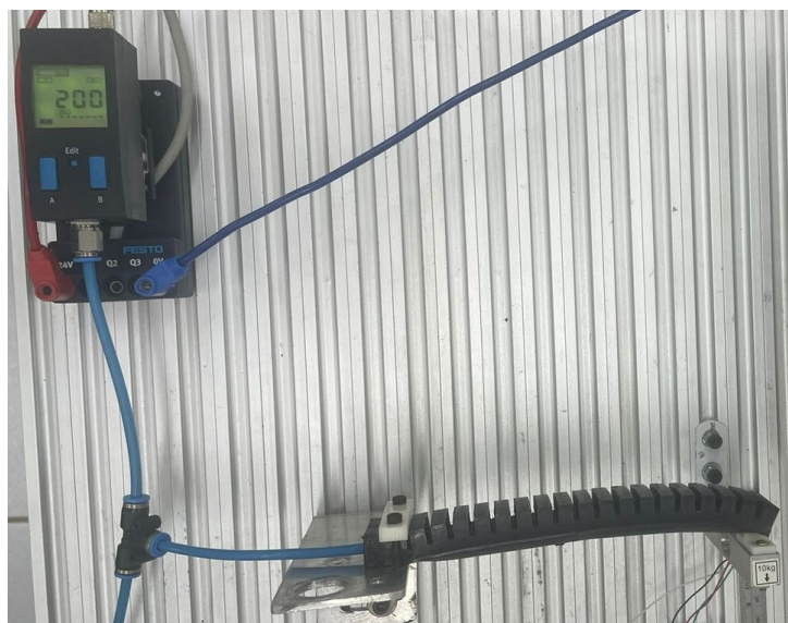
Figura 4.52: Coleta de força do atuador a 200kpa
