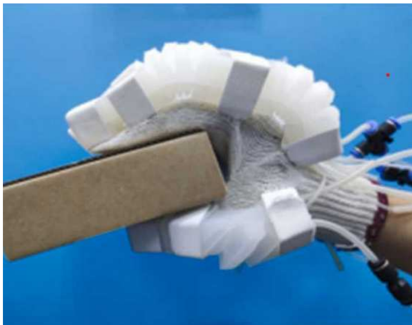
Figura 2.5: Exemplo de luva macia para reabilitação da mão baseada em atuadores pneumáticos tipo PneuNet, com os atuadores posicionados ao longo dos dedos para gerar flexão durante o inflamento. Adaptado de Wang et al. (Wang, F. et al. , 2022).
