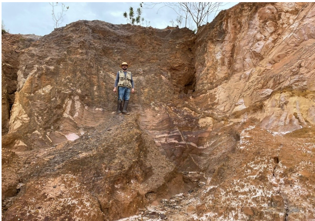
Figura 18: Afloramento de quartzitos ferruginosos, com coloração variando entre avermelhada, amarela e acinzentada, localmente magnéticos, indicando presença de minerais ferruginosos finamente disseminados na matriz (amostragem P3 I).
