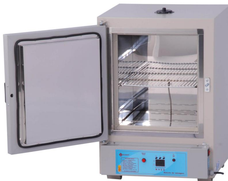
Figura 3.9 – Estufa laboratorial com controle PID utilizada para o aquecimento e controle de temperatura. Fonte: o autor.
