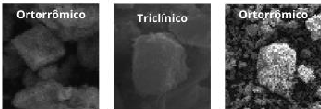
Figura 4. Imagens de Microscopia Eletrônica de Varredura do Remineralizador Kamafugito, destacando estruturas que se enquadraram em diferentes sistemas cristalinos.
