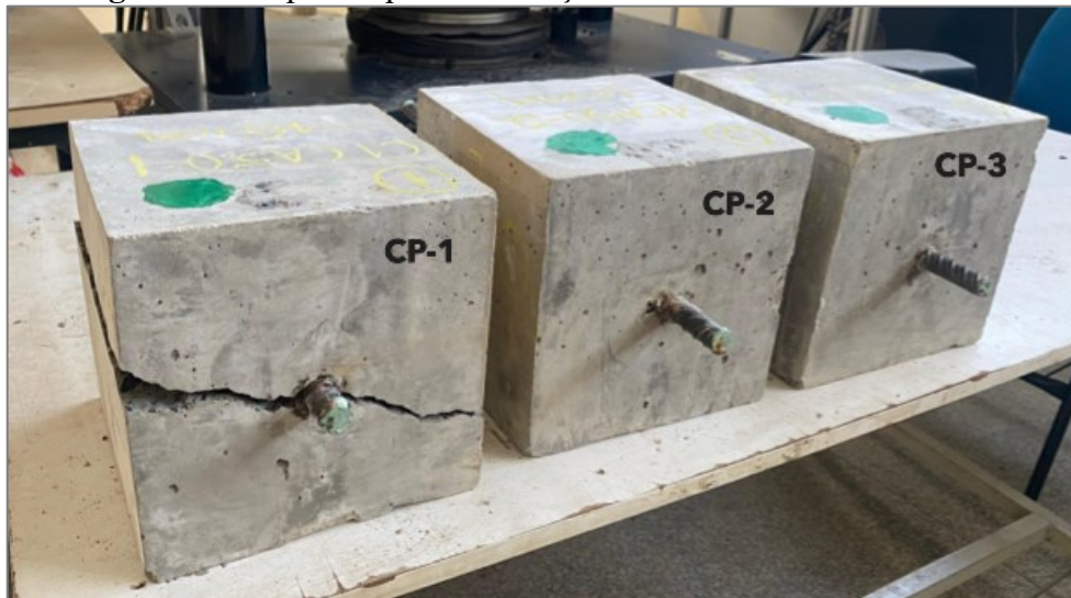
Figura 64 -Corpos de prova com aço CA-50 barras de 16 mm
