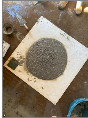
Figura 47- Ensaio de espalhamento C1
