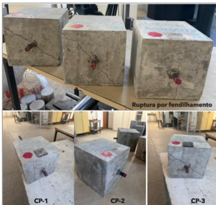
Figura 66- Corpos de prova CA-70 barras de 16 mm
