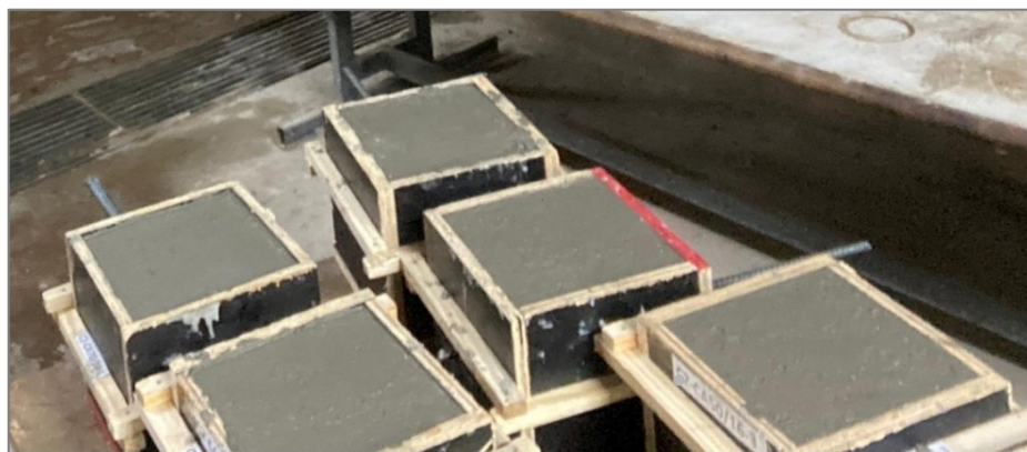
Figura 53- Formas preenchidas com o concreto C3
