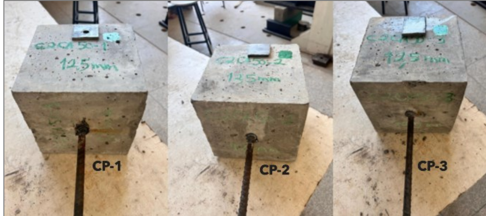
Figura 72- Corpos de prova com barras de aço CA-50 de 12,5 mm
