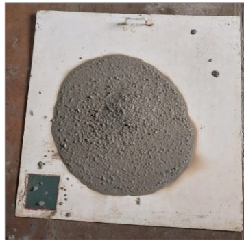
Figura 52- Ensaio de espalhamento C3
