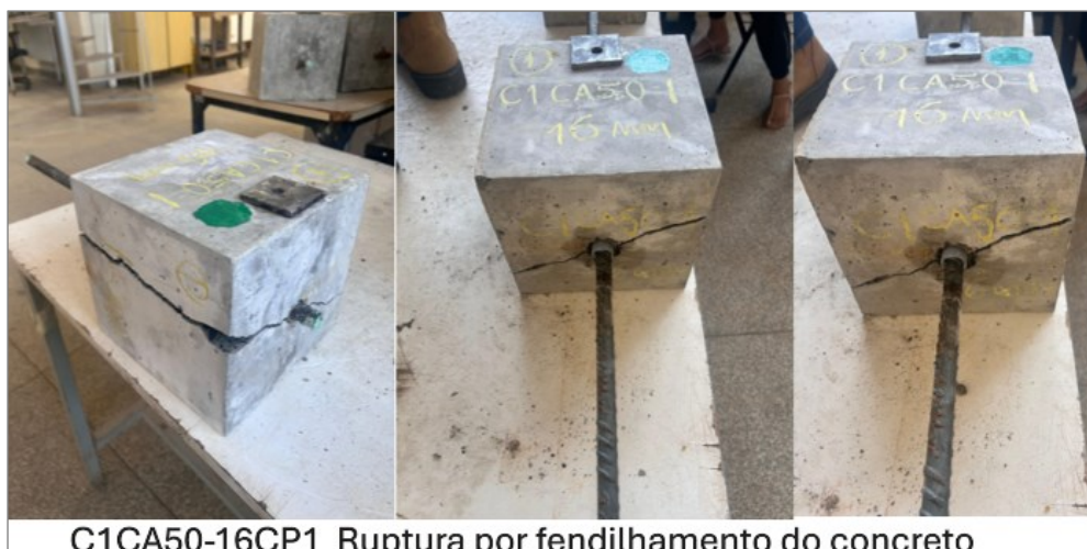
Figura 65 - Detalhes do corpo de prova CP1 Ø 16 mm com aço CA-50
