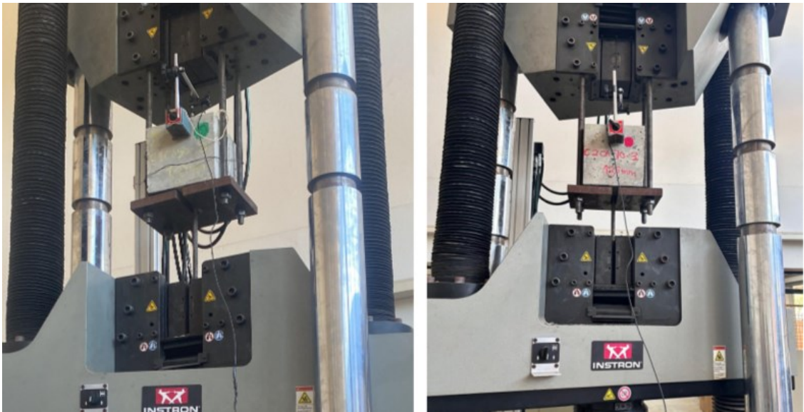
Figura 56- Realização dos ensaios de arrancamento
