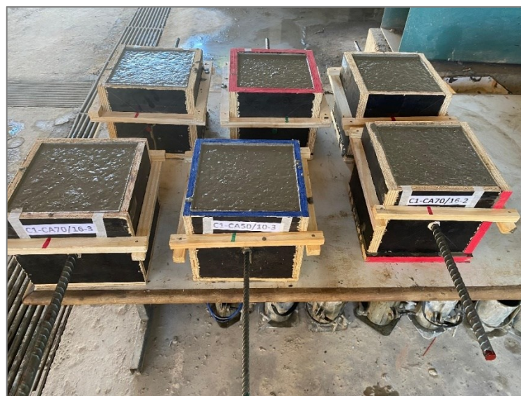
Figura 48- Formas preenchidas com concreto C1
