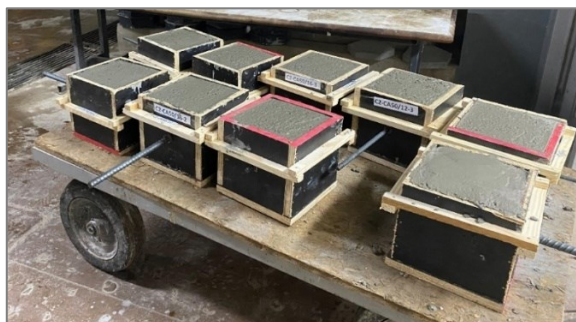
Figura 51- Formas preenchidas com concreto C2
