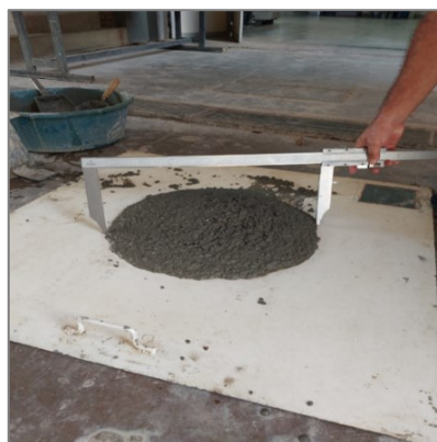
Figura 50- Ensaio de espalhamento C2
