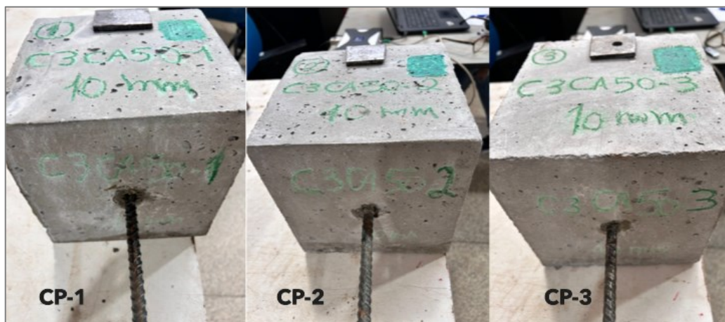
Figura 69- Corpos de prova com barras de aço CA-50 de 10 mm
