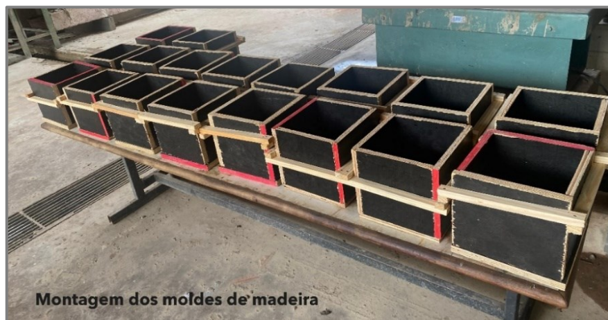
Figura 39- Formas de madeira montadas
