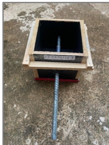
Figura 40- Molde com a barra inserida
