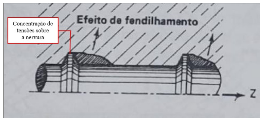
Figura 67- Região de concentração de tensões sobre as nervuras
