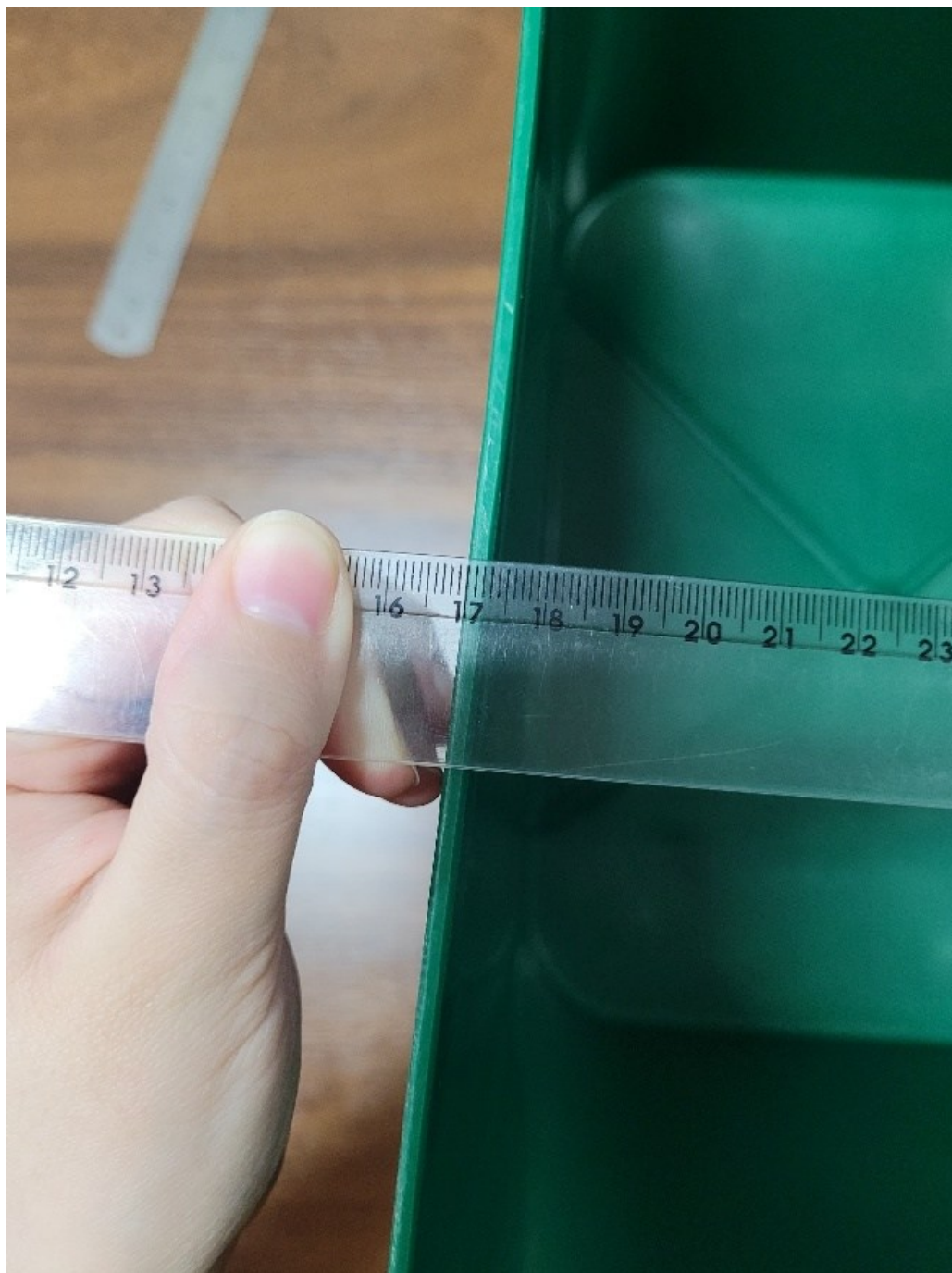
Figura 72 - Espessura da borda do armazenador, 3mm.
