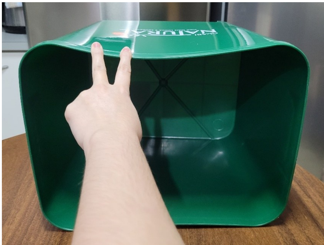
Figura 71 - Balde para armazenagem de ração feito de PP. Mesmo a borda sendo mais grossa, que a parede, não impediu a deformação com pouca força aplicada.
