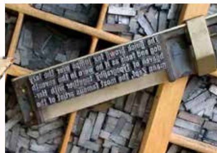
[fig. 4] Tipos móveis de metal. Fonte: Heidelberg (2004).
