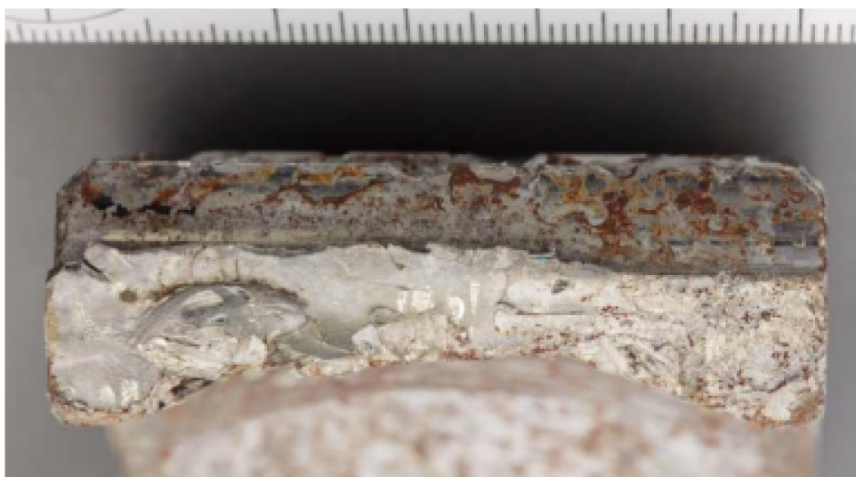
Figura 8 – Fratura devido a fadiga presente na engrenagem planetária do EC225 Puma.
