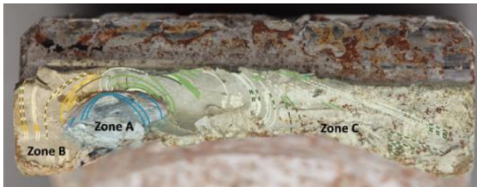
Figura 9 – Representação dos estágios da fratura devido a fadiga presente na engrenagem planetária do EC225 Puma.
