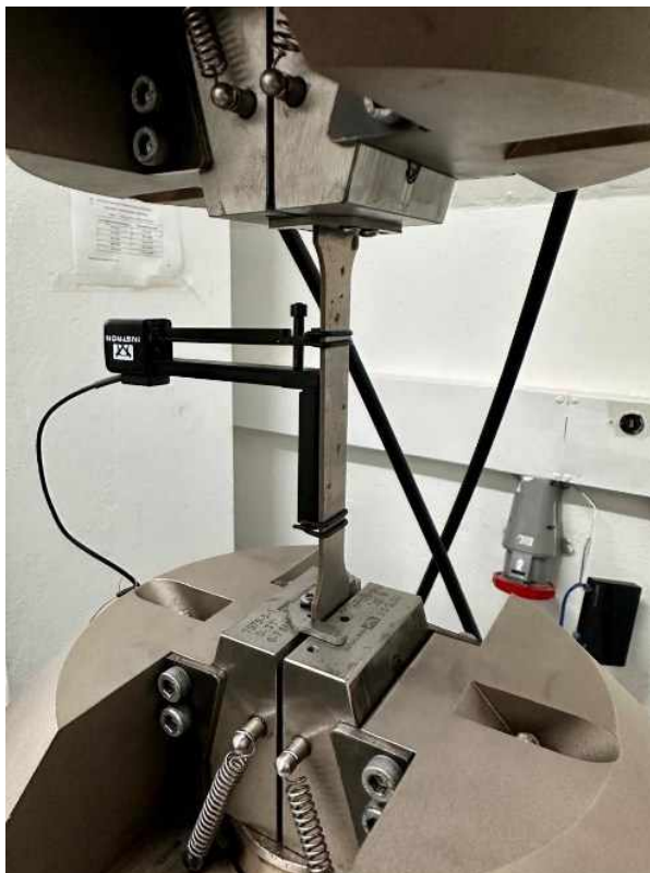
Figura 17: Ensaio de tração com corpo de prova ajustado na máquina de ensaio universal Instron .
