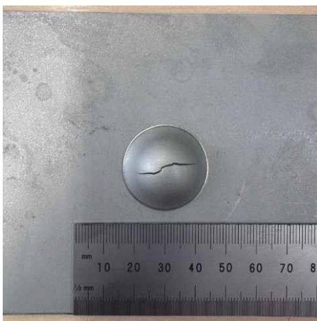
Figura 26: Corpo de prova após o ensaio de estiramento Erichsen.
