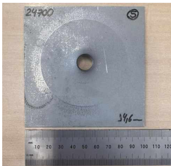
Figura 27: Corpo de prova após o ensaio de expansão de furo cônico.
