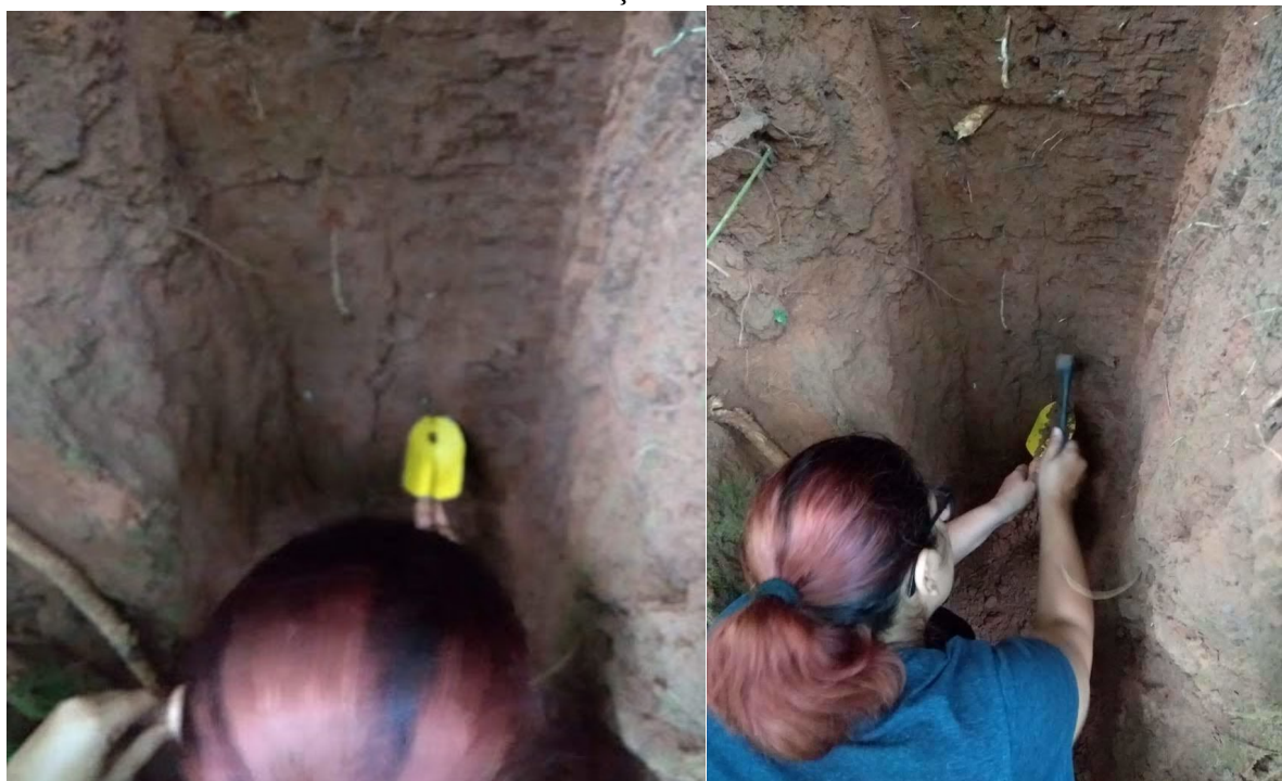
Figura 26. Solos amarelados associados aos Argissolos Amarelos encontrados nas cotas altimétricas médias do parque. Registro do perfil de solo em borda de erosão em forma de voçoroca.
