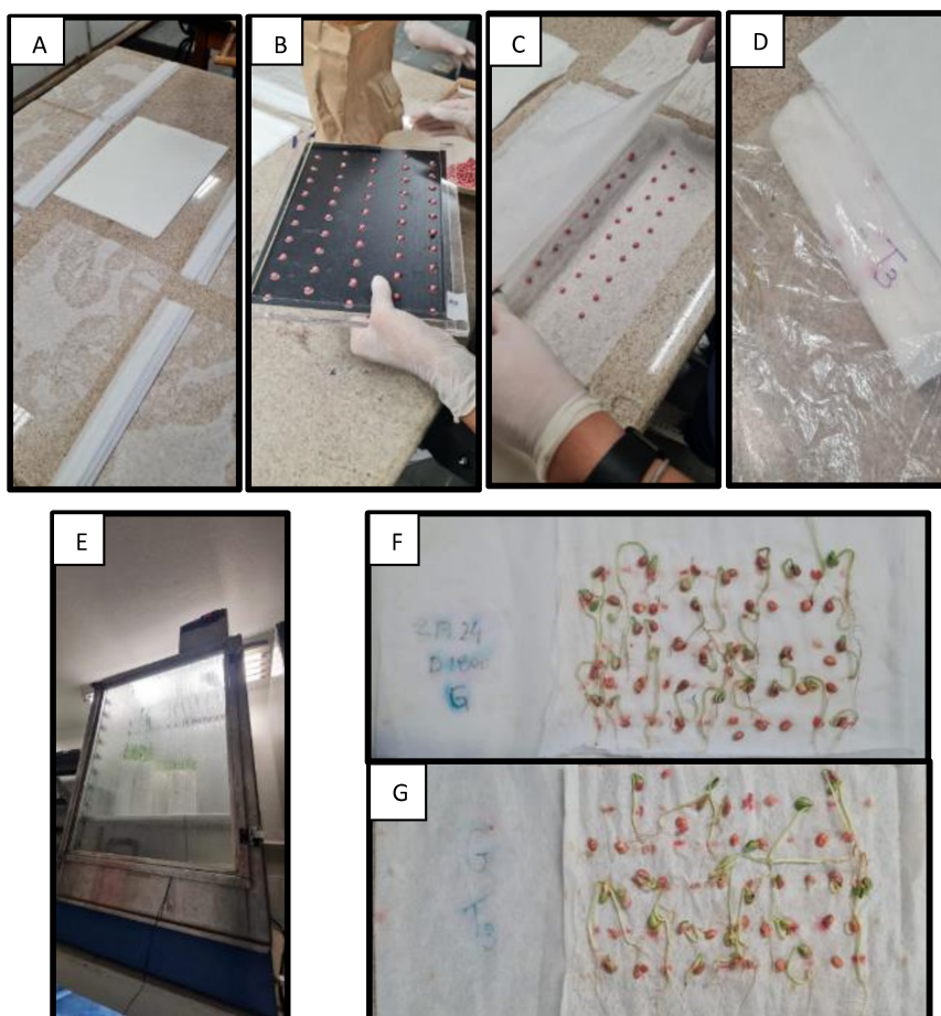
Figura 5: Processo de implementação e avaliação do teste germinação (A: papel Germitest embebido; B: gabarito de separação 50 sementes; C: sementes no papel; D: rolos envoltos por papel e armazenados no saco plástico; E: germinador B.O.D; F e G: sementes germinadas).
