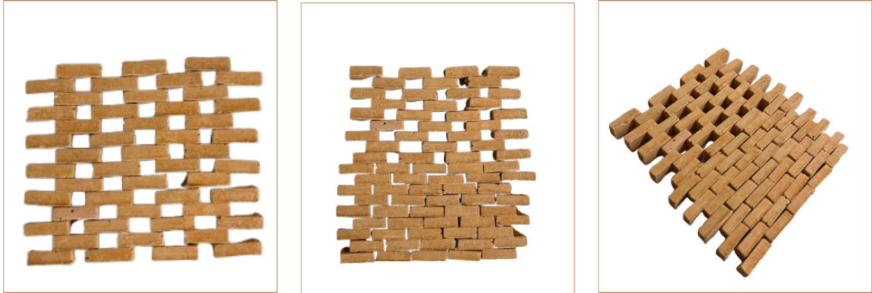
Figura 38 – Estudos dos materiais e raciocínio projetual construtivo. (a) Estudos de vigas e vedações via software Archicad. (b) Estudo de pilares, lajes e cobertura via software Archicad. (c) Protótipo de pilares e vedações em escala 1:10, com réplicas de tijolos. Fonte: Autora.
