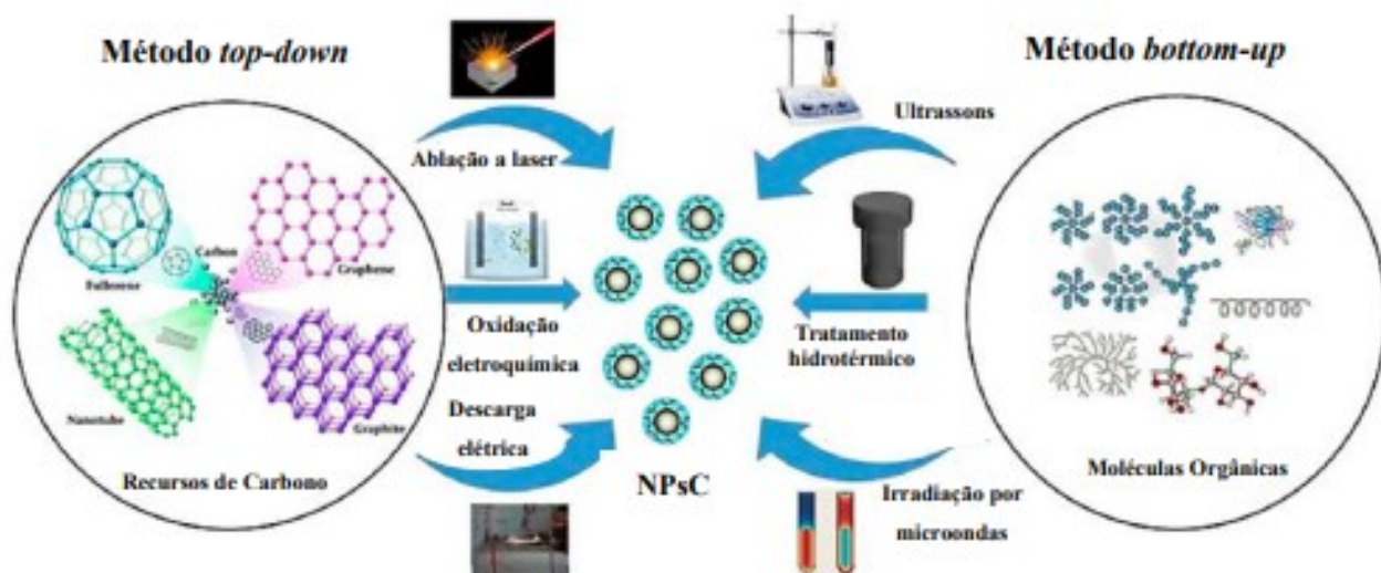
Figura 7: Esquema da síntese do tipo top-down e da síntese do tipo bottom-up .
