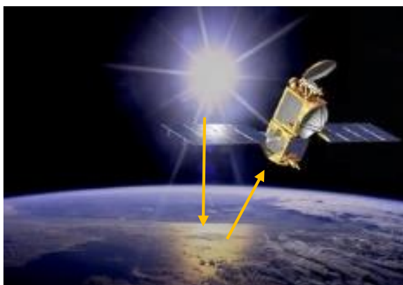
Figura 4: Sensores passivos, que utilizam o sol como fonte de radiação. Fonte: NASA, 2017 (adaptado)
