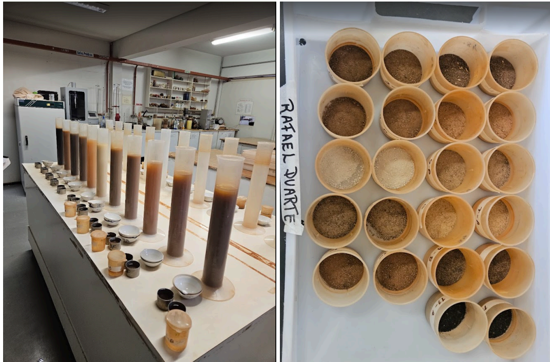
Figura 5. Preparo da amostra de solo para análise textural em laboratório e etapa de pipetagem durante a análise textural do solo. Fonte: Acervo do autor (2025).
