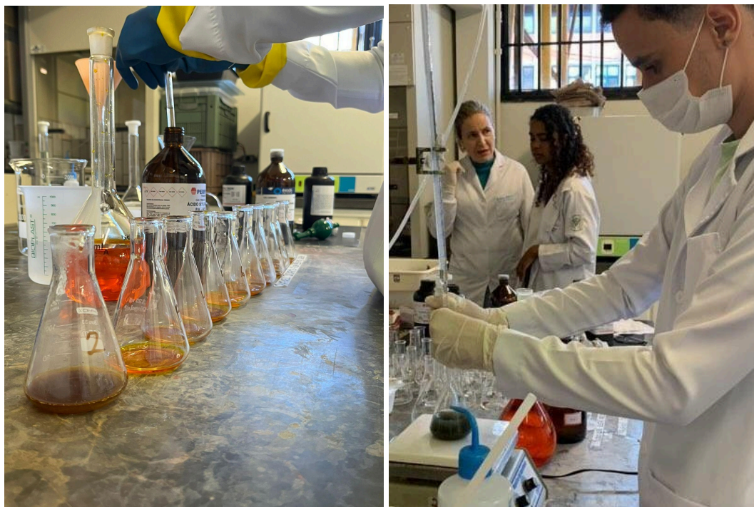
Figuras 3. Análises de teor de carbono orgânico no solo, método de Walkley-Black. Fonte: Acervo do autor (2024).
