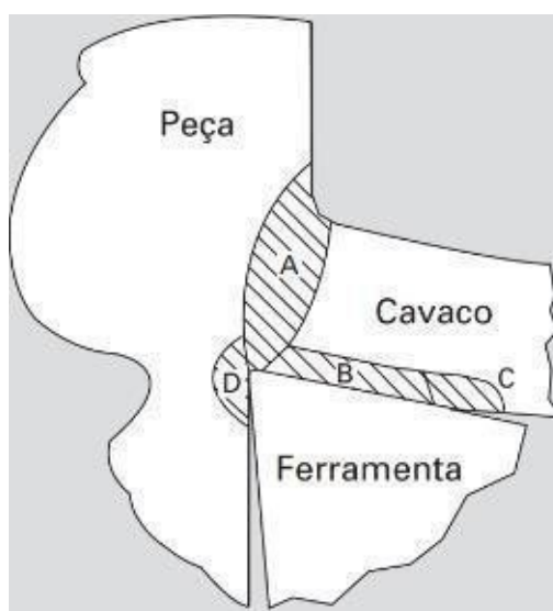
Figura 1 - Zonas de Geração de calor na usinagem. Fonte: Machado; et al (2015b).
