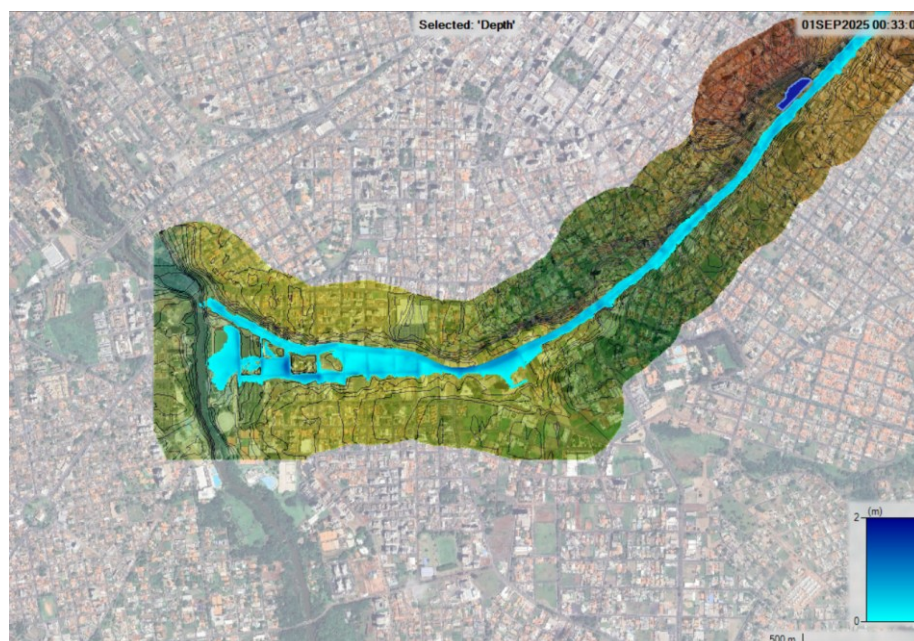
Figura 31 - Profundidades de alagamento quando a onda de cheia chega ao exutório (instante 33 minutos após início da precipitação) – com reservatório
