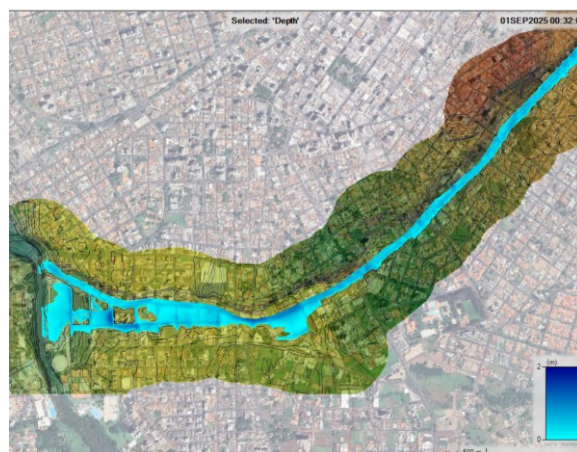
Figura 32 - Profundidades de alagamento quando a onda de cheia chega ao exutório (instante 32 minutos após início da precipitação) – sem reservatório.
