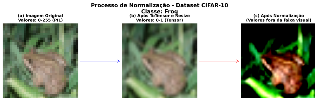
Figura 18 – Processo de normalização aplicado às imagens do dataset CIFAR-10. (a) Imagem original com valores de pixel 0-255; (b) Após conversão para tensor e redimensionamento ( 224 \times 224 ), com valores normalizados para 0-1; (c) Após normalização usando média e desvio padrão do ImageNet , resultando em valores otimizados para transfer learning mas não diretamente visualizáveis.
