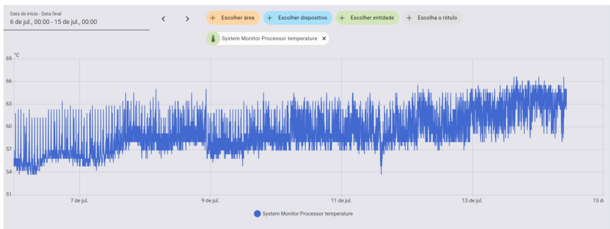
Figura 21 – Gráfico de temperatura da CPU uma semana antes da segunda falha.
