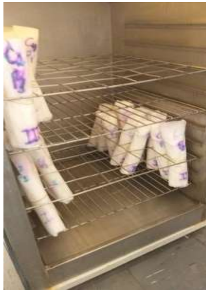
Figura 3- Rolos de germinação contendo as sementes de soja em germinador tipo Mangelsdorf regulado previamente a 25°C para o teste de comprimento de plântulas.
