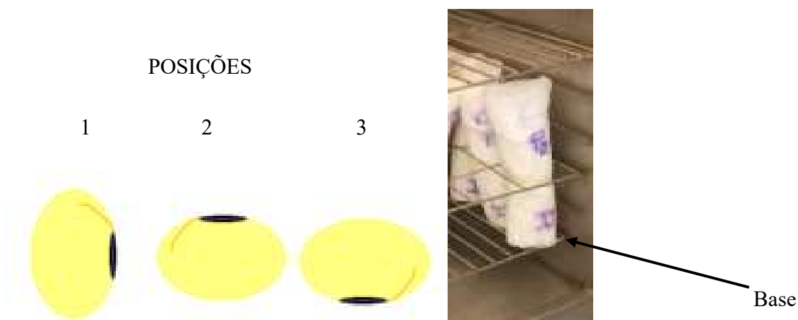
Figura 1- Esquema das estruturas da semente de soja e montagem no teste.
