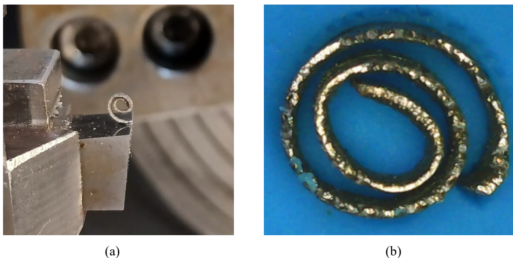
Figura 23 - (a) Cavaco retido na ferramenta após ensaio a 40 m/min. (b) Cavaco em formato espiral obtido em ensaio a 30 m/min
