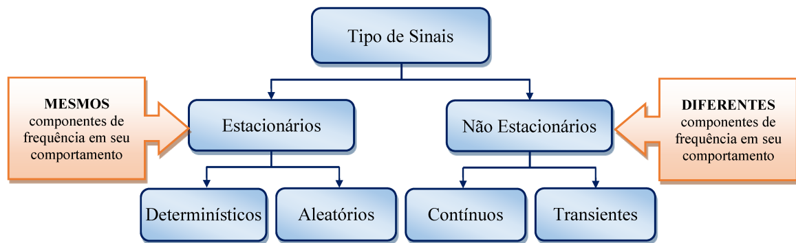
Figura 10 - Esquema dos tipos de sinais com classificações e exemplos. Fonte: Adaptado de SANTOS, 2021.
