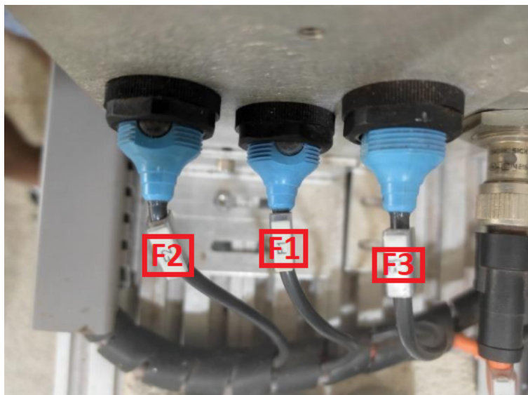
Figura 9 – Sensores ópticos posicionados com alturas diferentes: F1 (Sensor de peças pequenas), F2 (Sensor de peças médias) e F3 (Sensor de peças grandes). Fonte: Autoria própria.
