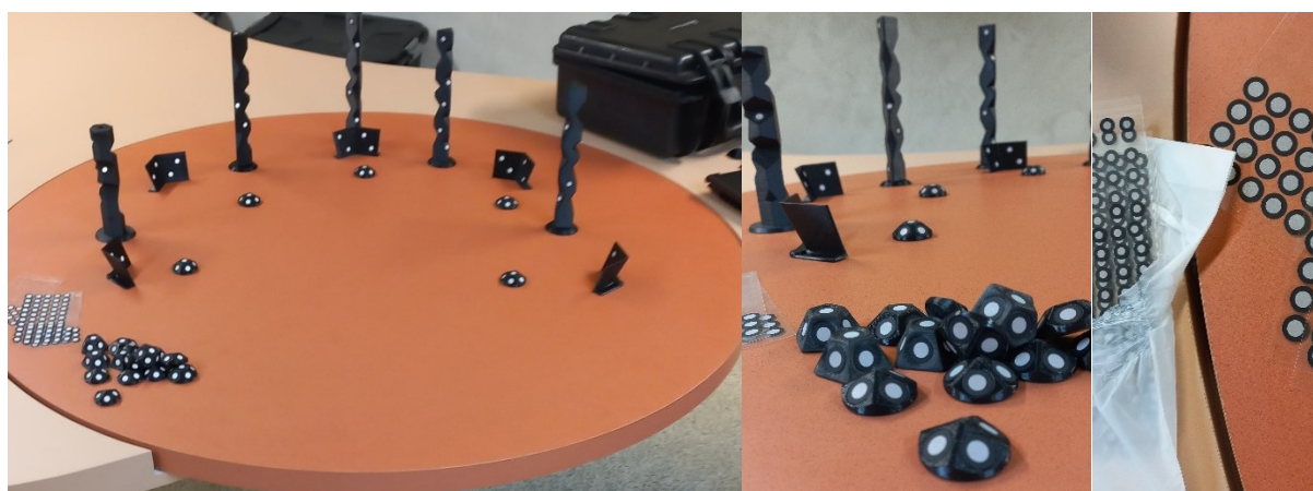
Figura 3.24 – Campo de escaneamento composto por elementos bases (estruturas em torre impressas em 3D) mapeados com marcadores adesivos reflexivos de 6 mm (chamados de pontos âncoras)
