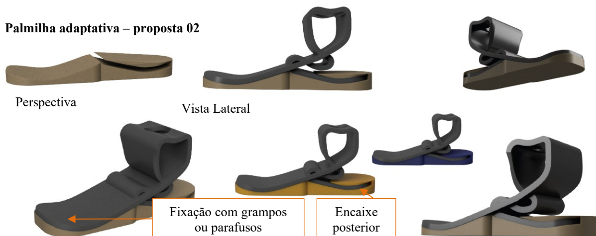
Figura 4.21 – Proposta de palmilha adaptativa 02: encaixe apenas em uma das extremidades proporcionando um Design visual leve
