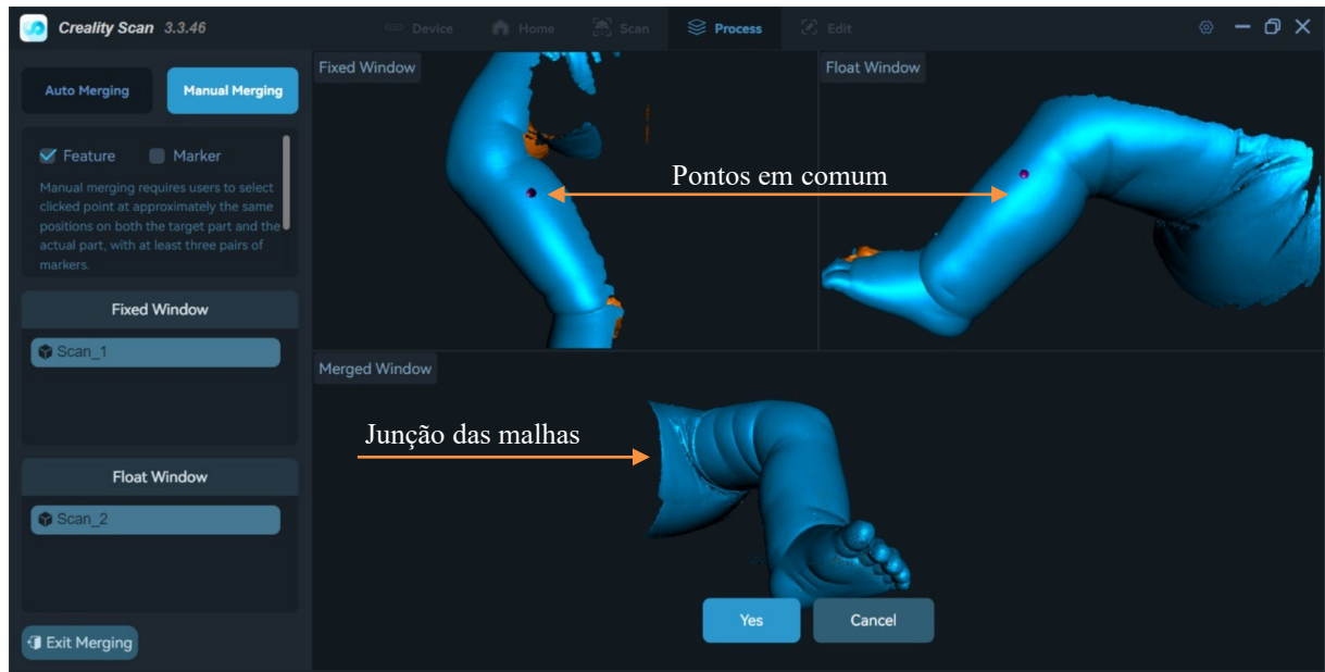
Figura 3.29 – Processo de junção do resultado dos dois processos de escaneamento, através da identificação de pontos em comum
