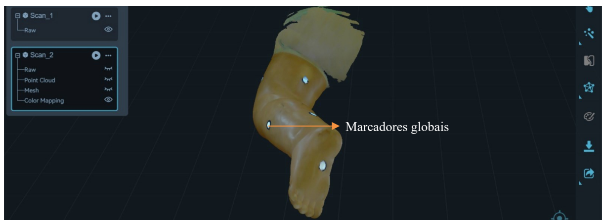
Figura 3.30 – Interface com o resultado do escaneamento do objeto com o mapa de cores, evidenciando todos os detalhes das tonalidades, bem como as manchas presentes na superfície e os marcadores globais
