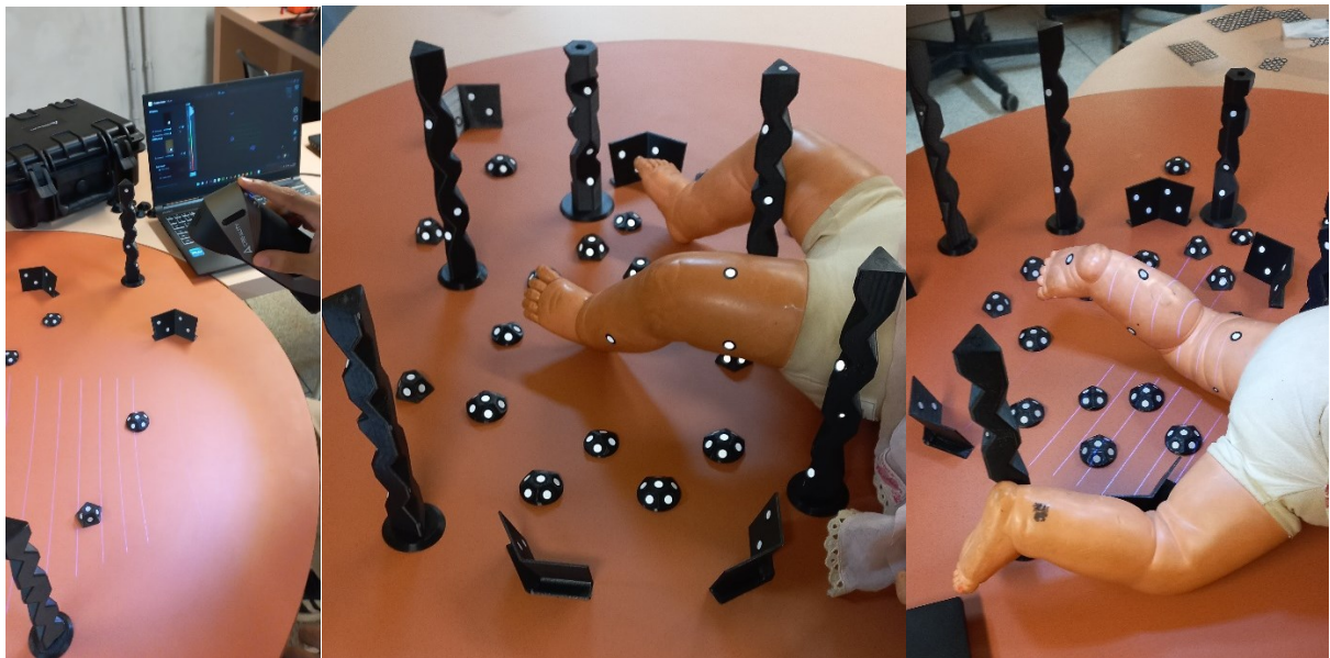
Figura 3.25 – Processo de escaneamento do objeto escolhido, realizado em três etapas: primeira etapa foi a colagem dos marcadores reflexivos, tanto no cenário quanto no objeto escaneado, a segunda etapa foi o escaneamento global do espaço e a terceira etapa consistiu na captura anterior e posterior da perna
