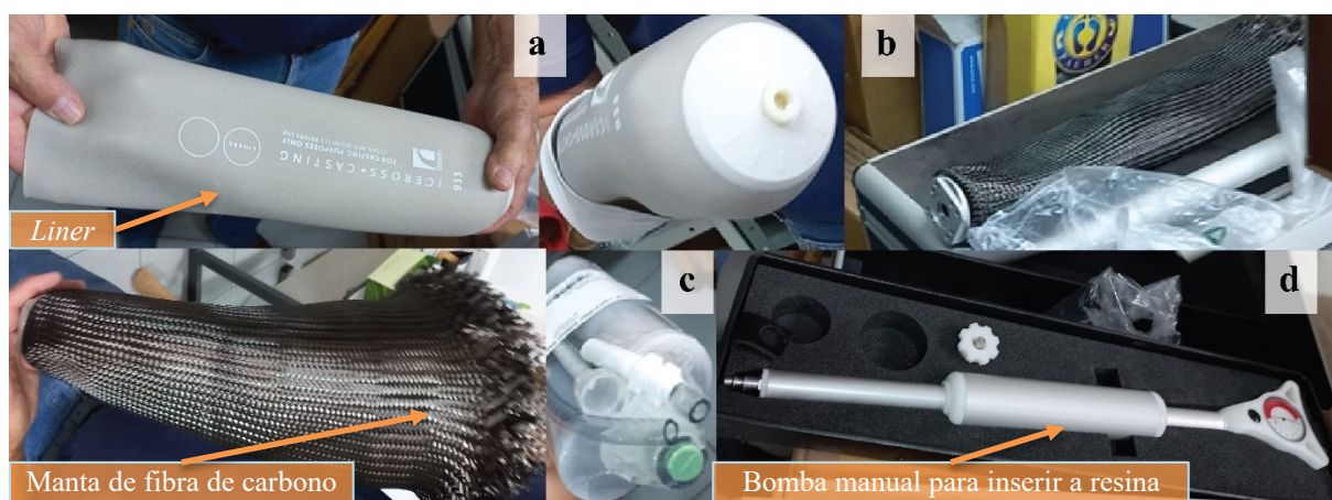
Figura 4.4 – Processo de fabricação de próteses da Ossur ® : (a) Liner : base para o molde direto; (b) reforço estrutural em malha de fibra de carbono; (c) resina e tubos para a conexão da bomba; (d) bomba de vácuo portátil
