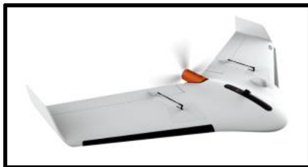
Figura 2: Exemplo De Modelo De RPA Com Asa Fixa.
