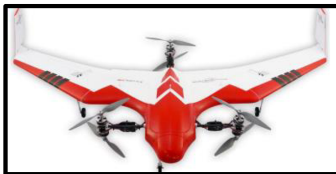
Figura 4: Configuração Híbrida De RPA Combinando Sistemas De Asa Fixa E Multirotores.
