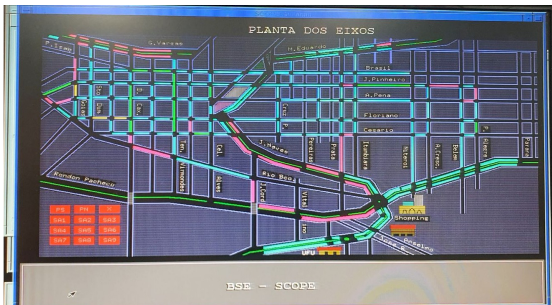
Figura 2 – Interface principal do sistema de monitoramento de tráfego da Prefeitura de Uberlândia, que mostra intensidade do fluxo veicular por cores em vias de parte dos bairros Centro, Nossa Sra. Aparecida e Saraiva.
