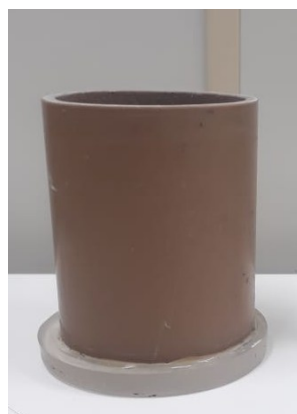
Figura 5: Recipiente usado para determinação da massa específica das misturas
