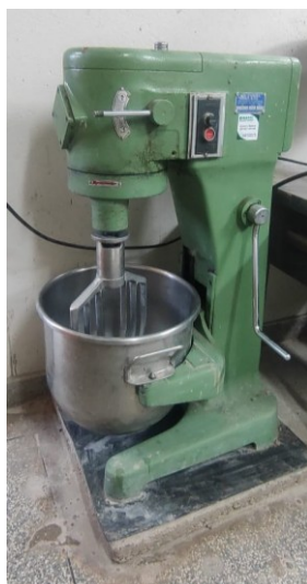
Figura 3: Argamassadeira planetária usada no preparo das misturas
