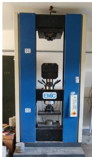
Figura 7: Máquina Universal de Ensaio utilizada para ensaios de resistência à compressão
