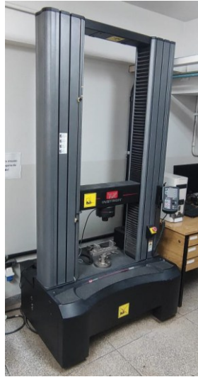
Figura 9: Máquina Universal de Ensaio utilizada para ensaio de flexão.
