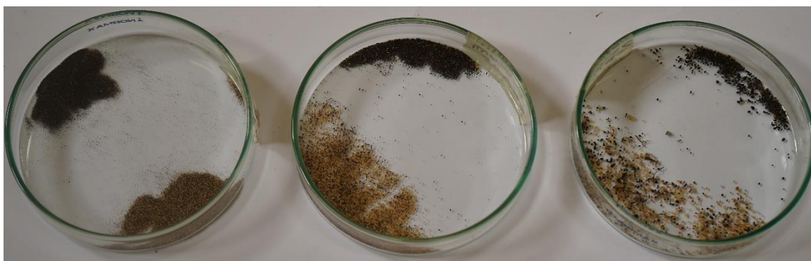
Figura 23 - Amostras do horizonte CB peneiradas com as seguintes aberturas: maiores que 500 \mu\text{m} , entre 200 \mu\text{m} e 500 \mu\text{m} , e menores que 200 \mu\text{m} e separadas em frações, distinguindo grãos de minerais magnéticos e não magnéticos.
