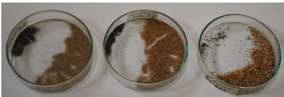
Figura 22 - Amostras do horizonte Bi peneiradas com as seguintes aberturas: maiores que 500 \mu\text{m} , entre 200 \mu\text{m} e 500 \mu\text{m} , e menores que 200 \mu\text{m} e separadas em frações, distinguindo grãos de minerais magnéticos e não magnéticos.
