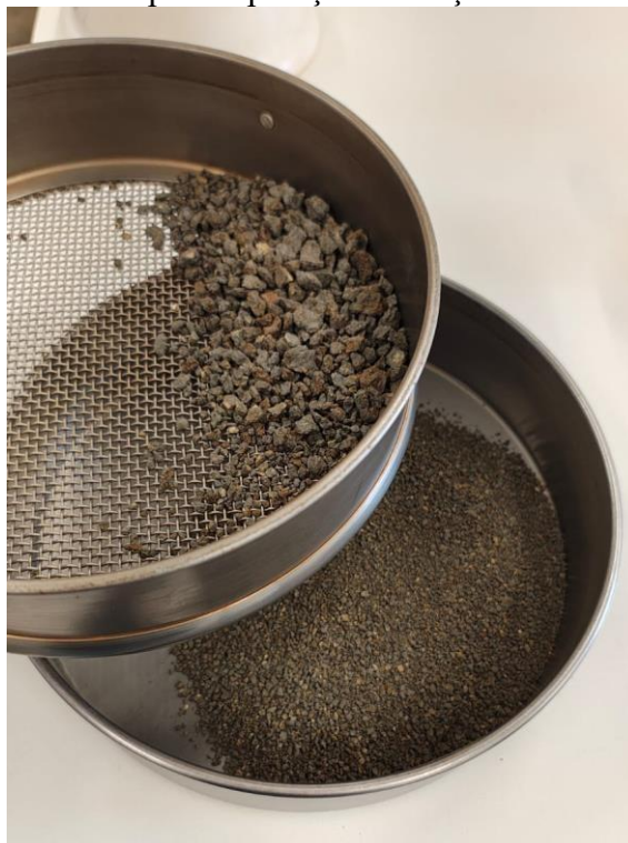
Figura 10 - Processo de peneiramento em malha 2,00 mm das amostras de solos coletadas para separação da fração terra fina.
