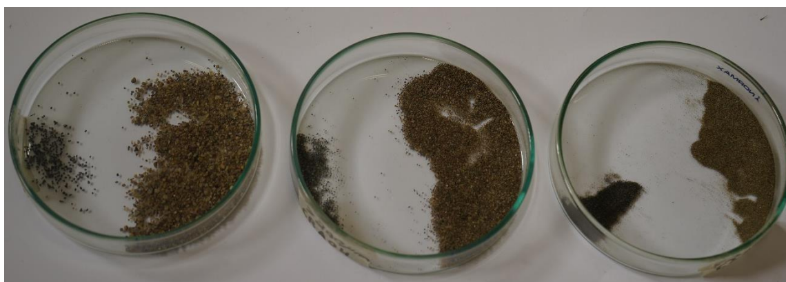
Figura 24 - Amostras do horizonte C peneiradas com as seguintes aberturas: maiores que 500 \mu\text{m} , entre 200 \mu\text{m} e 500 \mu\text{m} , e menores que 200 \mu\text{m} e separadas em frações, distinguindo grãos de minerais magnéticos e não magnéticos.
