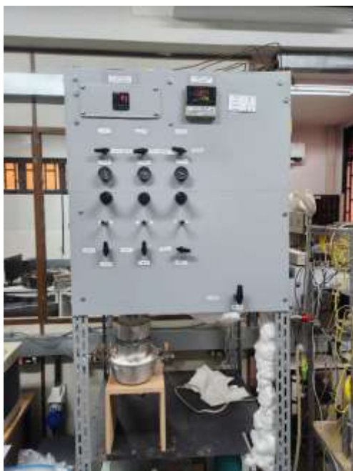
Figura 7: Unidade reacional utilizada nos testes catalíticos
