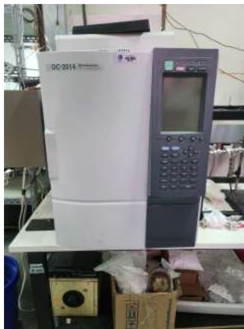
Figura 8: Cromatógrafo Shimadzu GC-2014 utilizado para análise dos produtos da reação.
