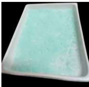
Figura 5: Catalisador 10%Ni/SiO 2 recém-impregnado, apresentando aspecto pastoso antes da etapa de secagem.
