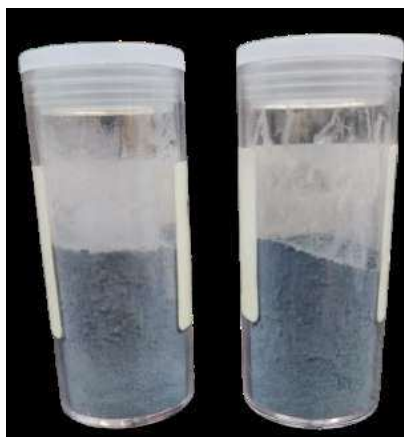
Figura 6: Catalisadores Ni/SiO 2 após a etapa de calcinação: à esquerda, o catalisador 10Ni/SiO 2 ; à direita, o catalisador 20%Ni/SiO 2 .
