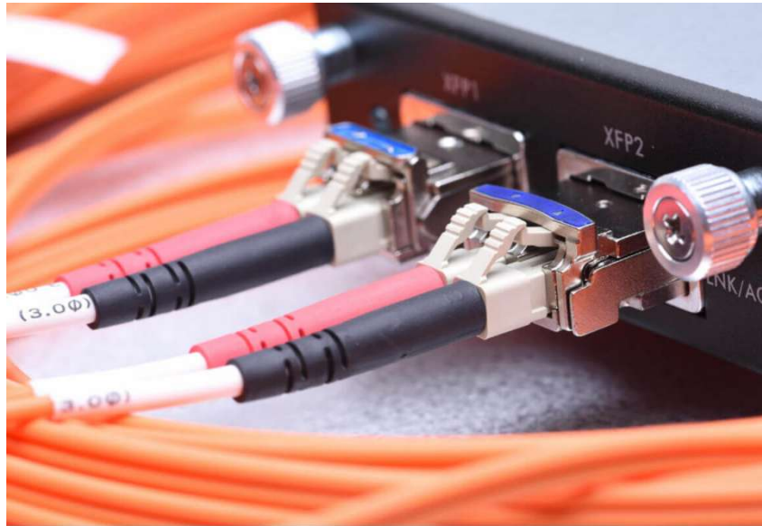
Figura 21 : Aplicação de uma GBIC em um equipamento de porta PON
