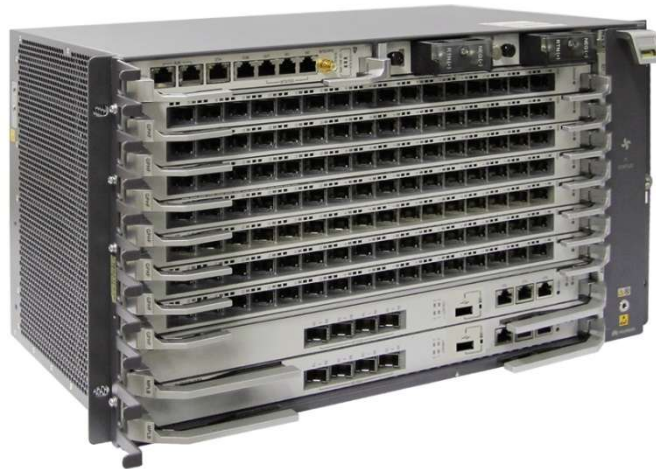
Figura 16 : Equipamento terminal de linha óptica com várias portas PON
