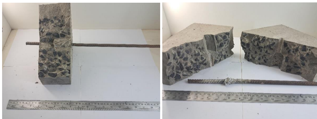
Figura 7 – CPs 11 e 12 de 10 mm fendilhados após ensaio (Fonte: Autor).
