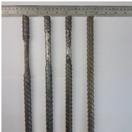
Figura 3 – Níveis de corrosão – 30%,20%,10% e inerte (Fonte: Autor).
