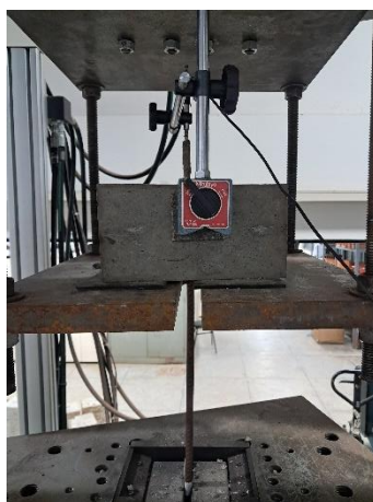
Figura 6 – Ensaio de arrancamento (Fonte: Autor).
