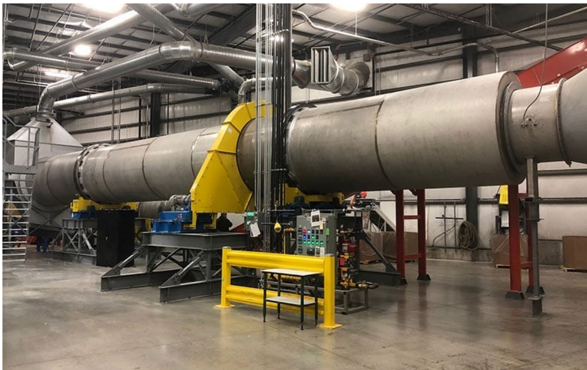
Figura 14. Secador direto com câmara de combustão (FEECO).
