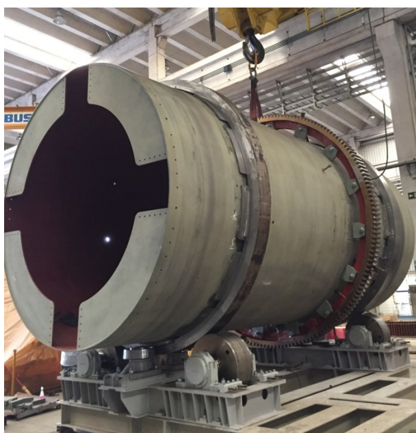
Figura 6. Tambor granulador YARA, para unidade de Serra do Salitre em Minas Gerais (YARA, 2019).
