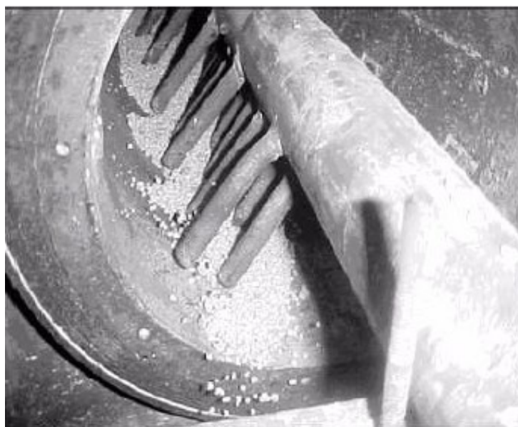
Figura 25. Interior de secador roto fluidizado (ARRUDA, 2008).
