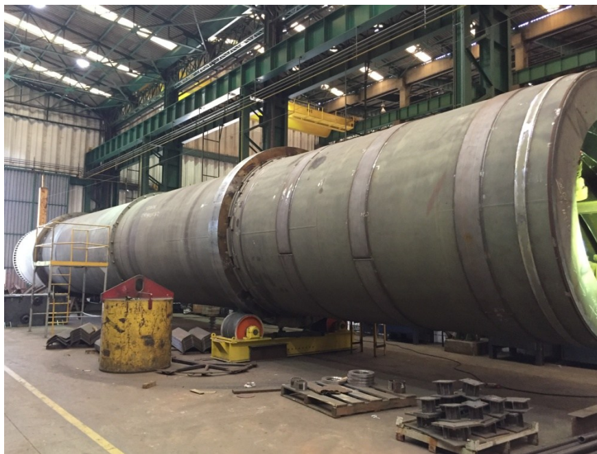
Figura 7. Tambor secador YARA, para unidade de Serra do Salitre em Minas Gerais (YARA, 2019).
