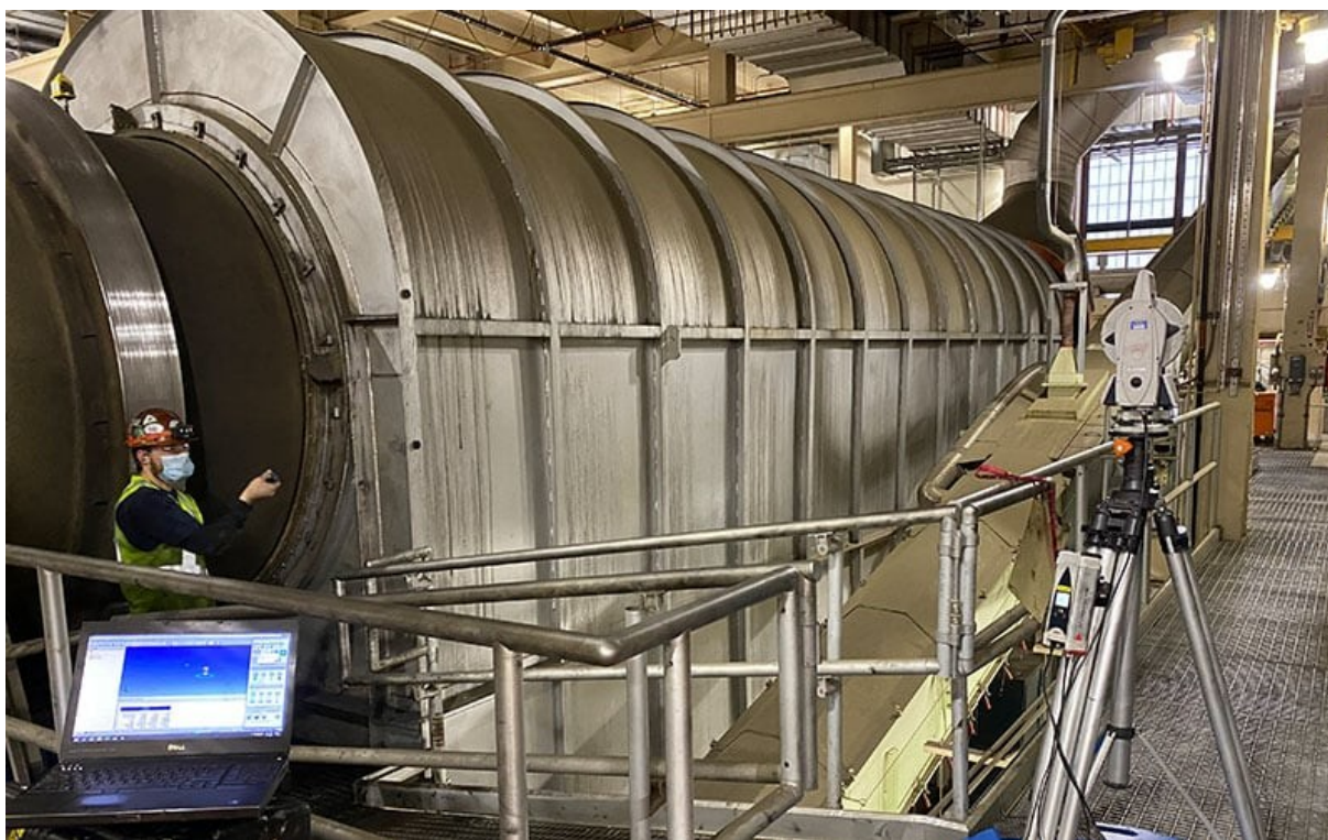
Figura 15. Secador indireto (FEECO).
