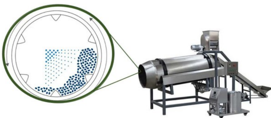
Figura 20. Esquema de processo de revestimento em tambor (ES'HAGHI et al., 2024).
