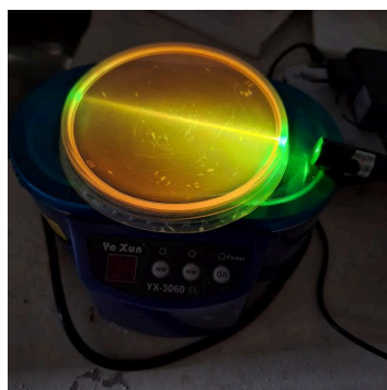
Figura 12: Lente polimérica iluminada com laser verde em processo de cura
