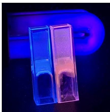
Figura 10 - Cubetas com MEH-PPV e Resina polimérica bicomponente expostas a luz violeta
