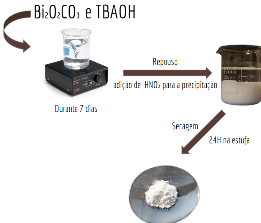
Figura 7. Processo de Esfoliação do \text{Bi}_2\text{O}_2\text{CO}_3
