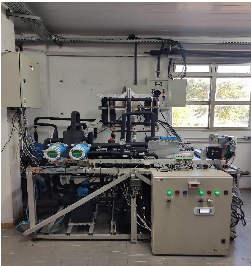
Figura 3.2 Bancada experimental do ciclo de refrigeração transcrito.
