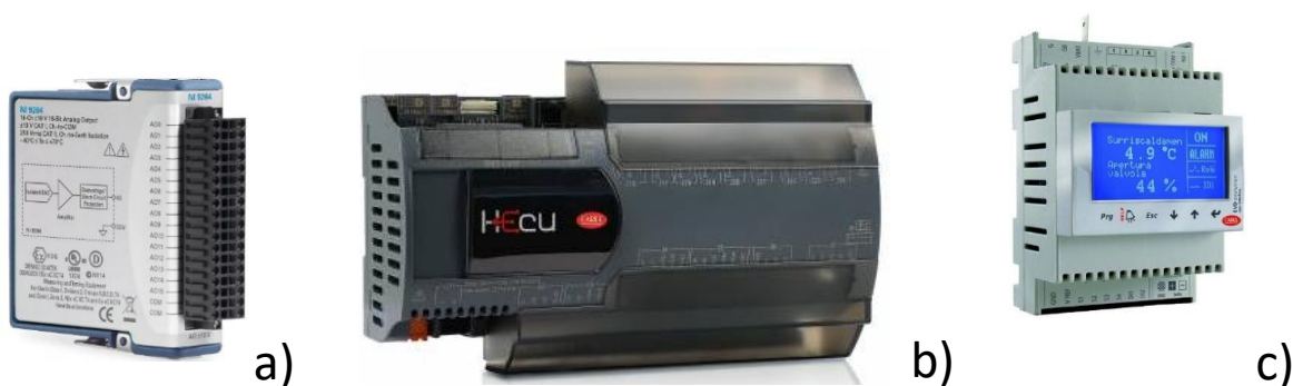
Figura 3.17 Controladores utilizados no ciclo de refrigeração transcrito. a) NI 9264 para o controle de temperatura de evaporação, b) CLP HECU ECU70TS0C0 para controlar a temperatura de saída do resfriador de gases e rotação do compressor e c) controlador EVD EVD0000T50 para o controle de superaquecimento na sucção do compressor.
