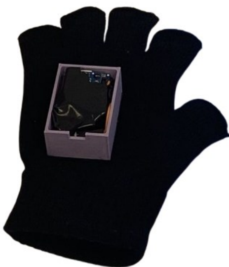
Figura 11 – Luva com o dispositivo de sensor inercial
