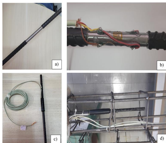
Figura C2 – Processo de execução da instrumentação - a) Limpeza das barras; b) Ligações completas; c) Proteção realizada; d) Fixação das barras na armadura da estaca.
