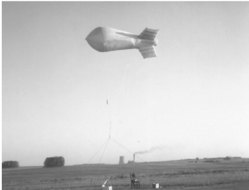
Figura 2. Balão cativo implementado para análise vertical (CONTI, 2006).
