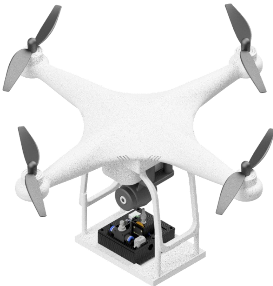
Figura 13. Modelo 3D da plataforma lab-on-a-drone configuração completa para monitoramento da qualidade do ar.
