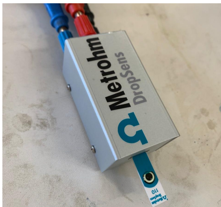
Figura 7. Fotografia do esquema experimental da célula eletroquímica (eletrodo impresso de carbono em solução) no conector.
