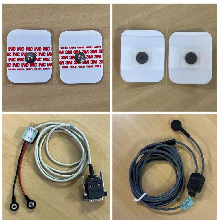
Figura 3: Eletrodo de superfície passivo para eletromiografia e referência, vista ventral (A) e vista dorsal (B); Pré-amplificador diferencial com cabo para eletromiografia (C); Cabo para eletrodo de referência (D).
